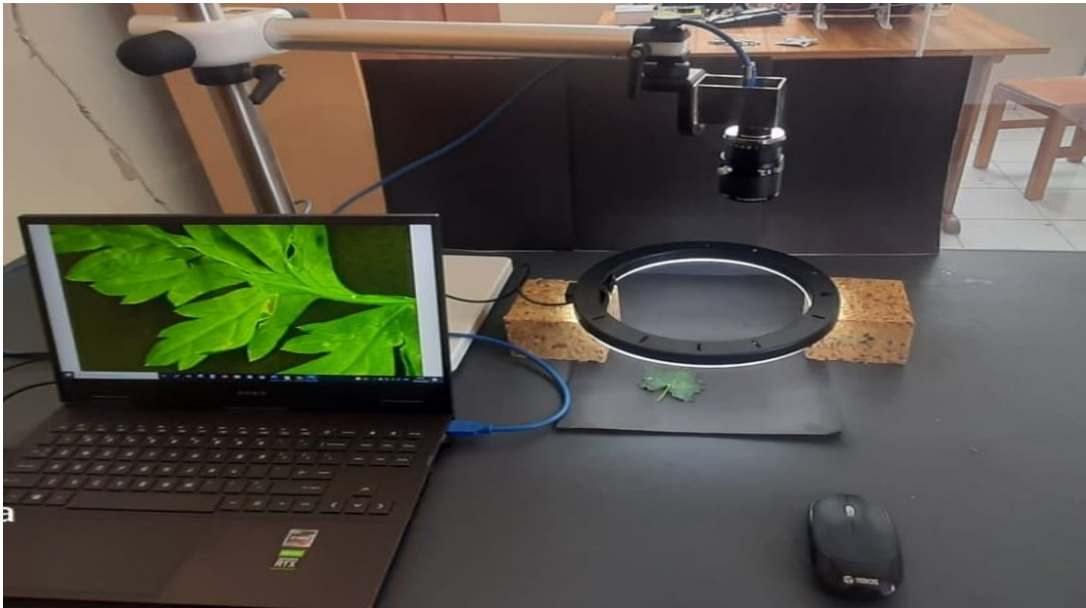
Calibración de cámara EO-2323 y lente telecéntrico de 55 mm para la captura de imágenes de hojas en el laboratorio de la escuela profesional de Ingeniería Agroindustrial de la UNA-Puno
