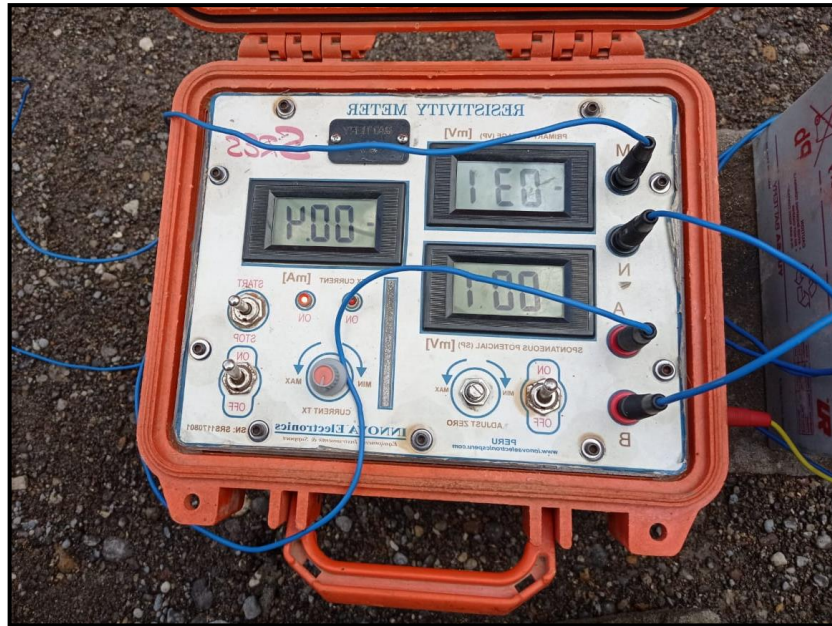
Figura 17: Georesistivmetro utilizado para los SEV en la zona de estudio. Fuente fotografía propia
