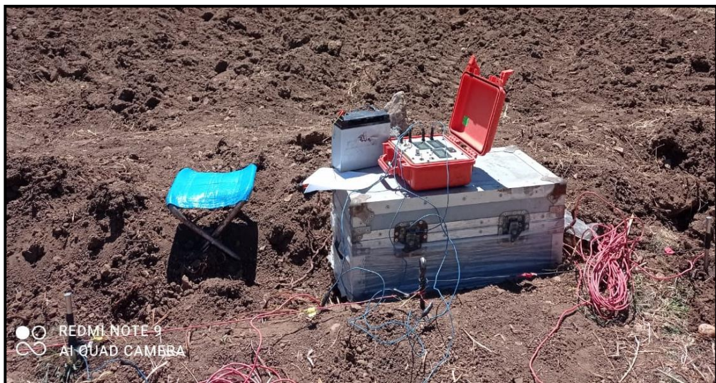
Figura 16: Equipo utilizado para los SEV en la zona de estudio. Fuente fotografía propia
