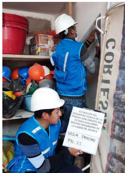
*Nota.* En la figura se muestra la realización del ensayo de esclerometría en los elementos estructurales de la tribuna nor-oriental del estadio GBR.
