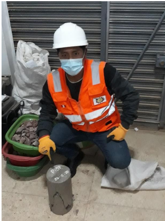
Fotografía 13. Rotura por compresión de la probeta cilíndrica de concreto
