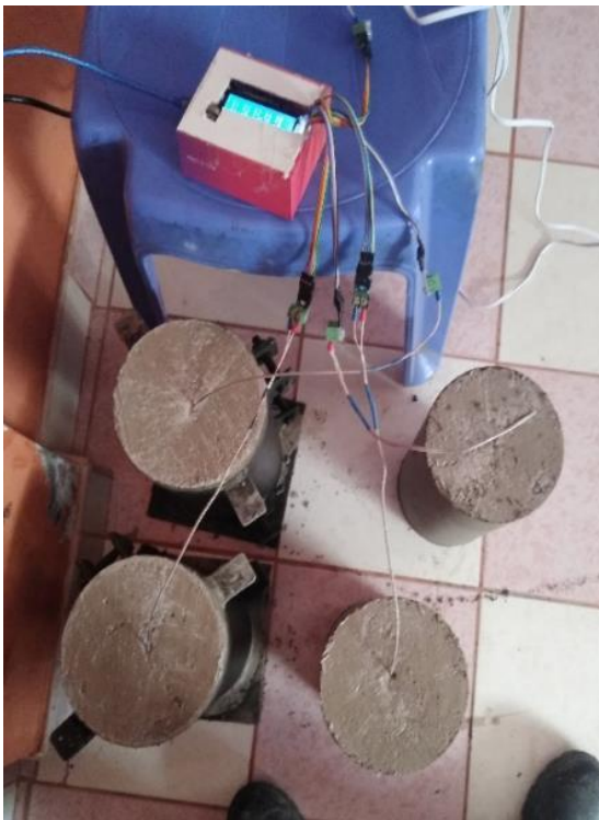
Fotografía 7. Desmolde de las probetas cilíndricas instrumentadas con sensores de temperatura.
