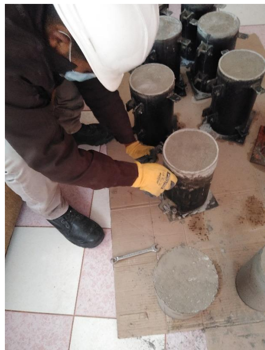
Fotografía 8. Desmolde de las probetas cilíndricas para determinar la resistencia a la compresión – 1ra tanda
