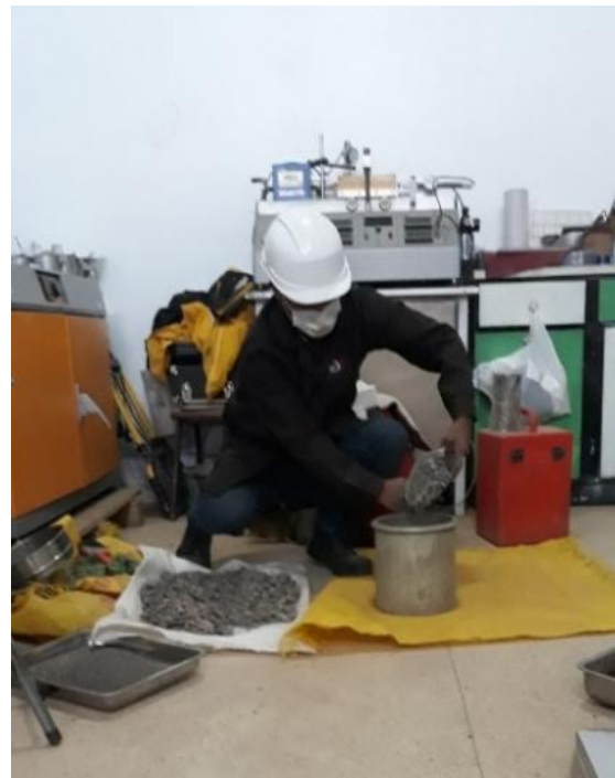
Fotografía 4. Llenado del agregado grueso al molde
