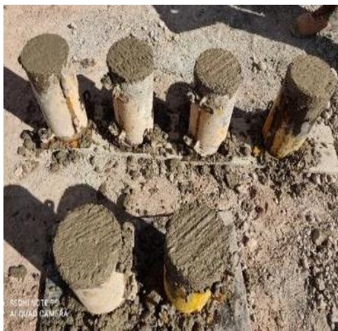
Fotografía 15. Acabado de las seis probetas elaboradoras en obra
