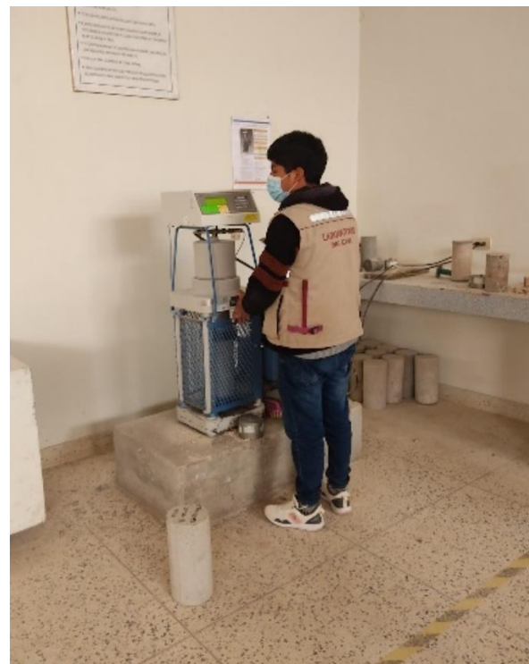
Fotografía 20. Ensayo de rotura de probetas cilíndricas curadas en obra a la edad de 7 días.
