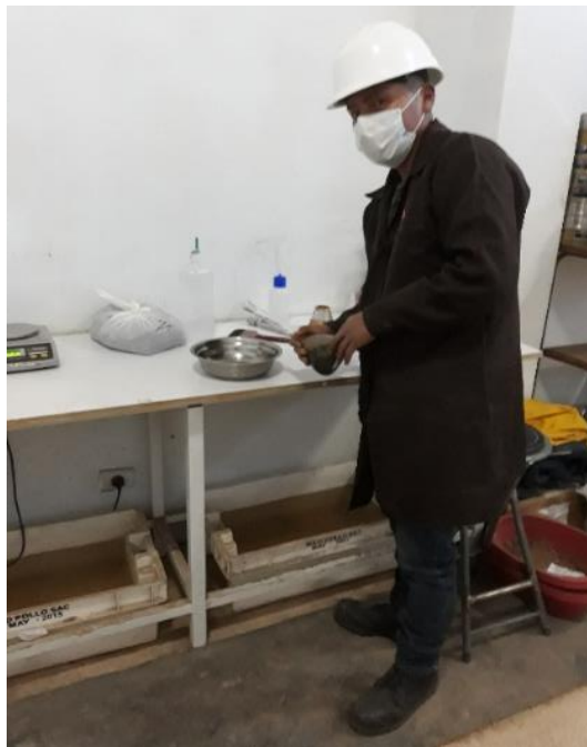
Fotografía 3. Decantación del exceso de agua para evitar pérdidas de finos en el ensayo de densidad relativa.
