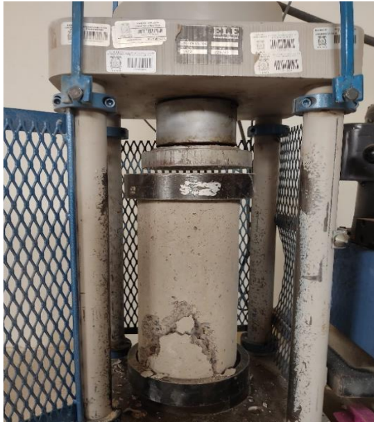
Fotografía 21. Fisura de la probeta cilíndrica de concreto curado en obra.
