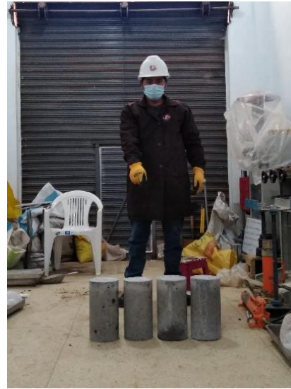
Fotografía 10. Probetas cilíndricas de concreto antes del ensayo estándar – 1 día de edad
