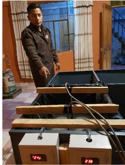
Fotografía 27. Curado a temperatura constante de las probetas cilíndricas de concreto
