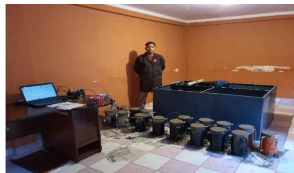
Fotografía 25. Probetas de concreto que serán curadas a temperatura constante
