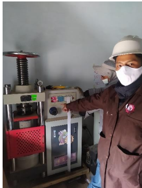
Fotografía 29. Ensayo de rotura de probetas cilíndricas a la edad de 28 días para la corroboración de datos
