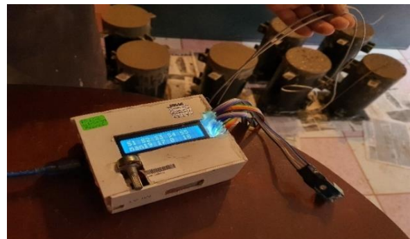
Fotografía 25. Probetas de concreto que serán curadas a temperatura constante
