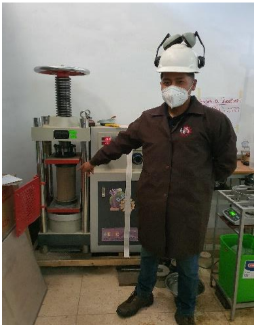
Fotografía 28. Ensayo de rotura de probetas cilíndricas a la edad de 14 días para la corroboración de datos
