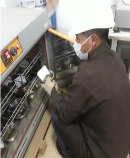
Fotografía 3. Decantación del exceso de agua para evitar pérdidas de finos en el ensayo de densidad relativa.
