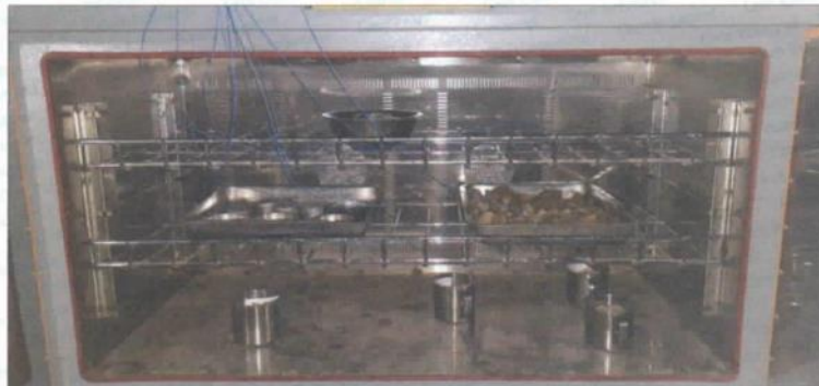
Fotografía mostrando la ubicación de los sensores de temperatura en el medio isoterma.
