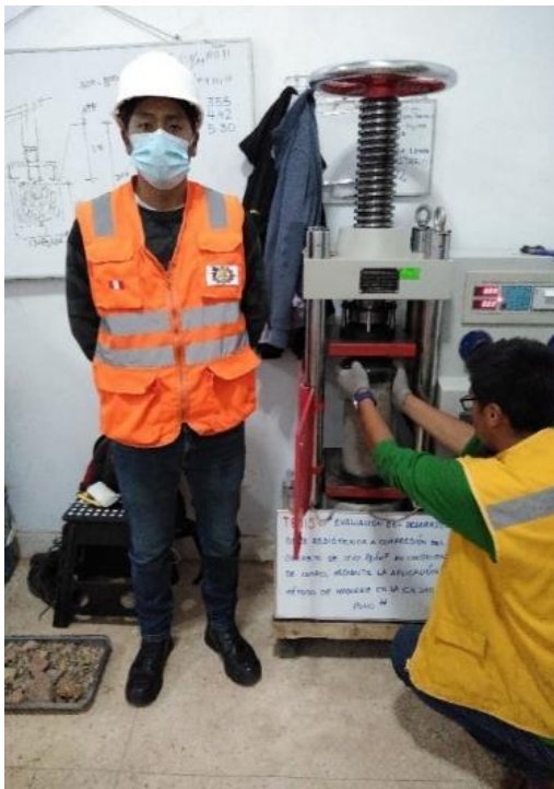
Fotografía 11. Ensayo estándar de resistencia a la compresión del concreto – 5 días de edad
