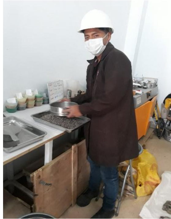
Fotografía 2. Tamizado del agregado grueso
