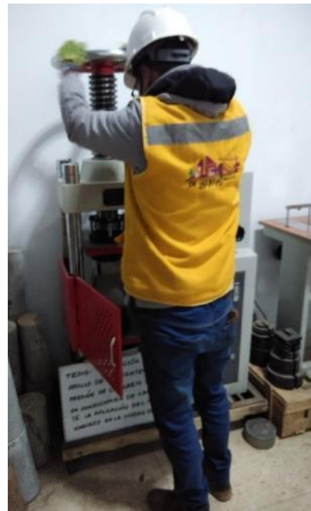
Fotografía 12. Ensayo estándar de resistencia a la compresión del concreto – 14 días de edad
