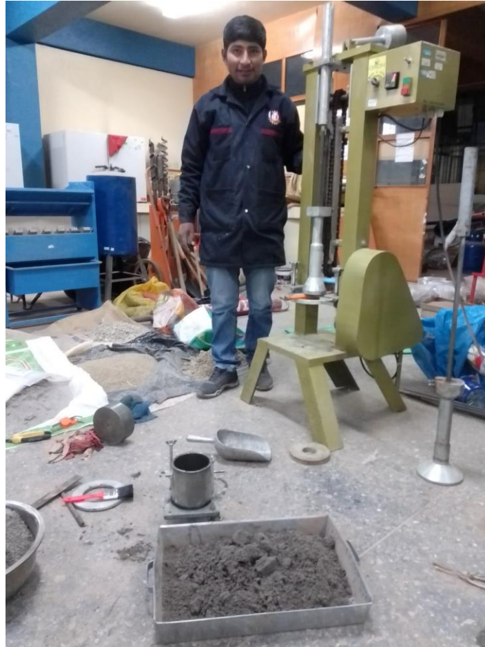
COMPACTACION CON UN EQUIPO AUTOMATICO
