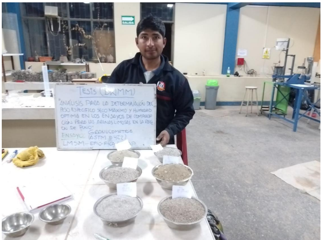
SELECCIÓN DE MUESTRAS PARA EL ANALISIS GRANULOMETRICO
