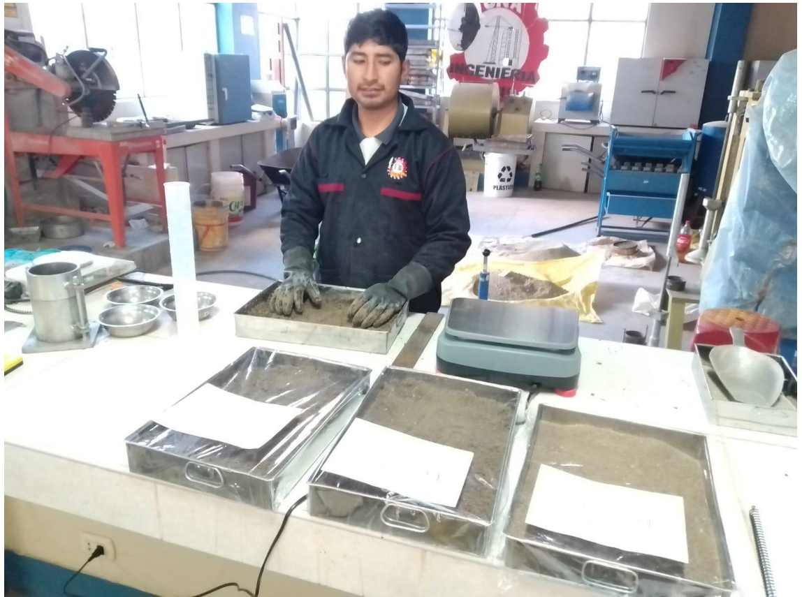
PREPARACION DE MUESTRAS PARA ENSAYO DE COMPACTACION
