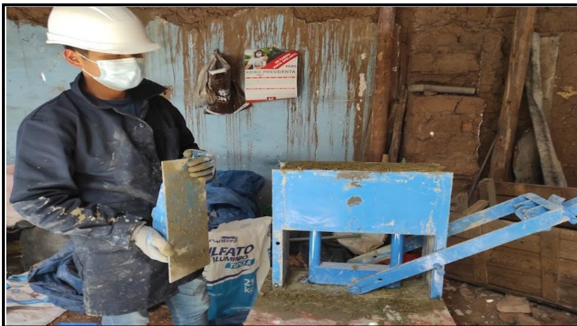
Fotografía 21. VISTA DEL MOLDEO DEL BLOQUE
