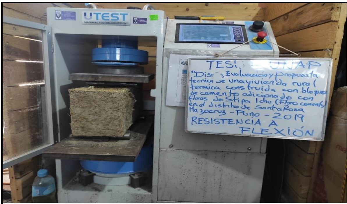
Fotografía 40 . VISTA DE LA MUESTRA SOMETIDA A FLEXION
