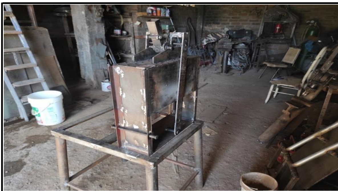
Fotografía 05. VISTA DEL MOLDE PARA LA FABRICACION DEL BLOQUE
