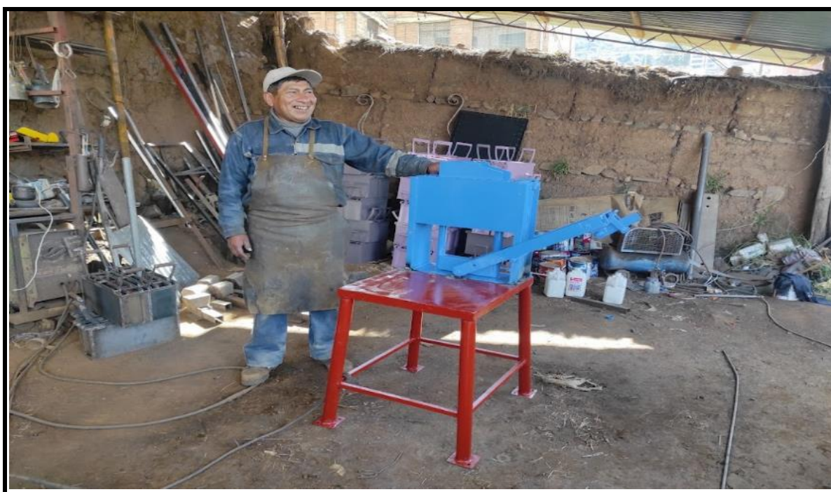
Fotografía 06.VISTA FINAL DEL MOLDE PARA LA FABRICACION DEL BLOQUE
