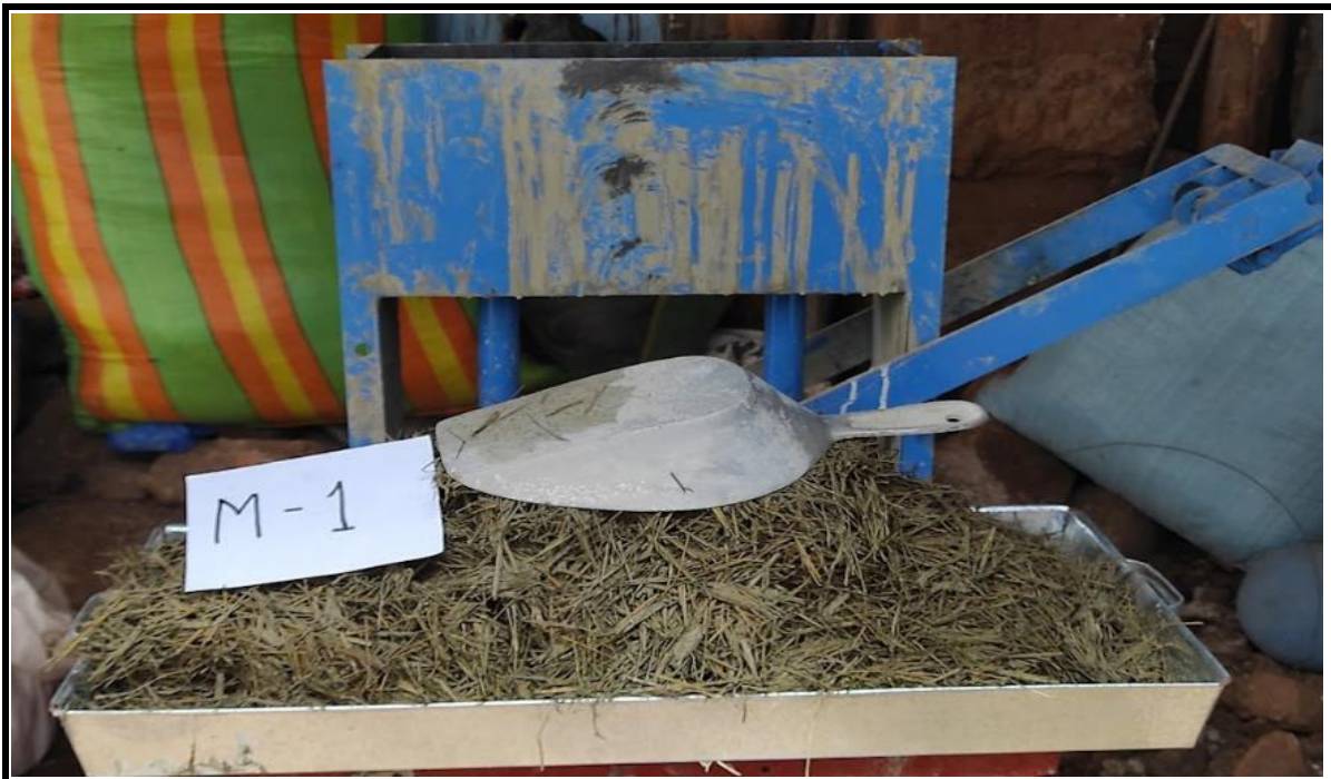
Fotografía 20. VISTA DE LA MEZCLA PARA LA FABRICACION DEL BLOQUE
