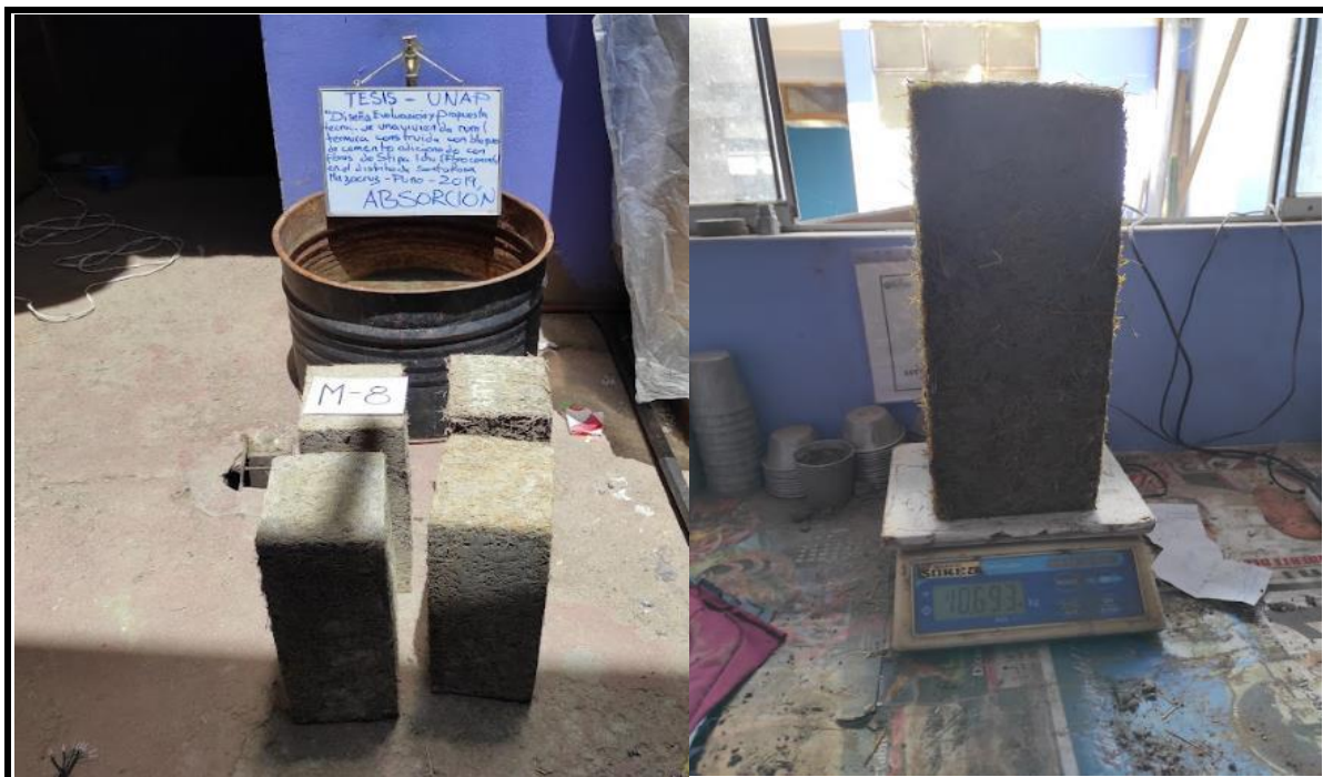
Fotografía 30. VISTA DEL PESO SATURADO DURANTE 24 HRS
