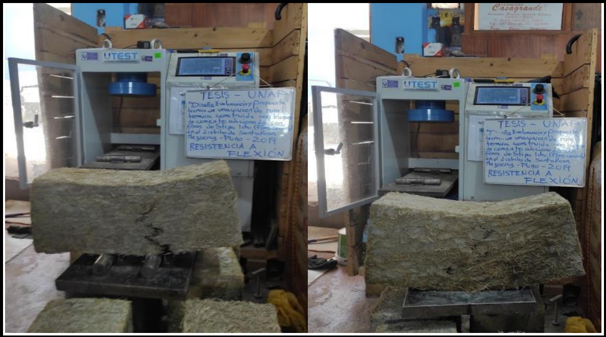
Fotografía 43. VISTA DE MUESTRAS DESPUES DE SOMETIDAS A FLEXION Fecha: 12/07/2021
