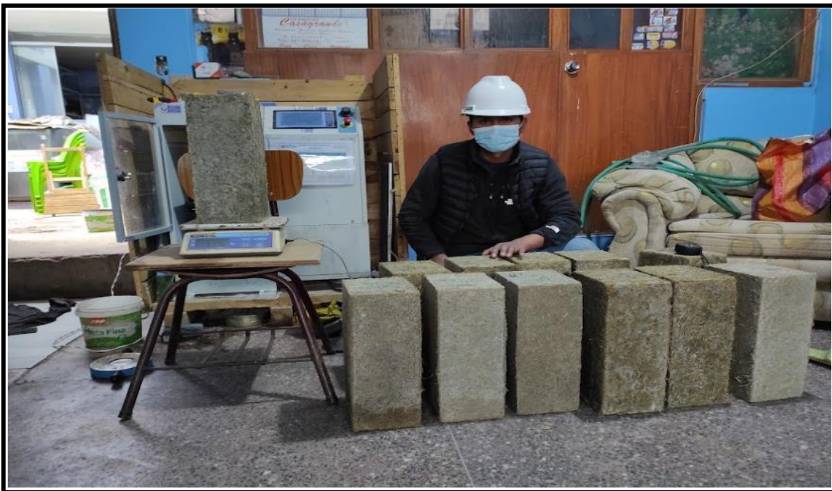
Fotografía 26. VISTA DE MUESTRAS PARA VARIACION DIMENSIONAL
