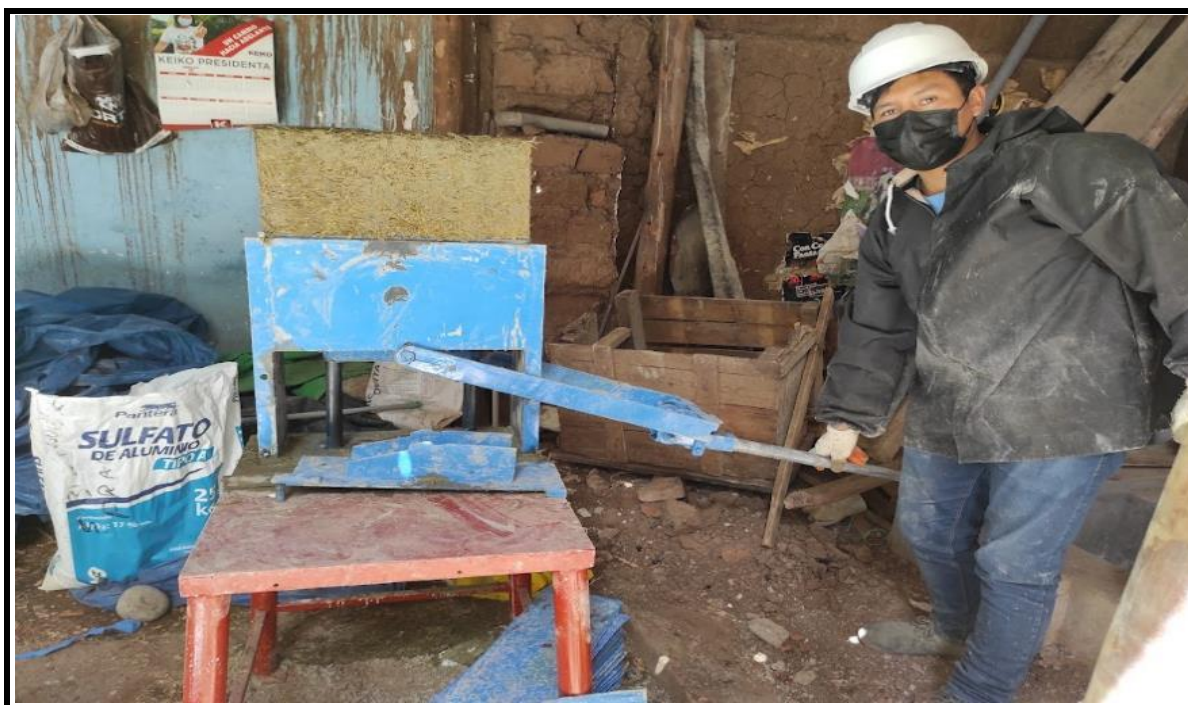
Fotografía 22. VISTA DE LA EXTRACCION DEL BLOQUE
