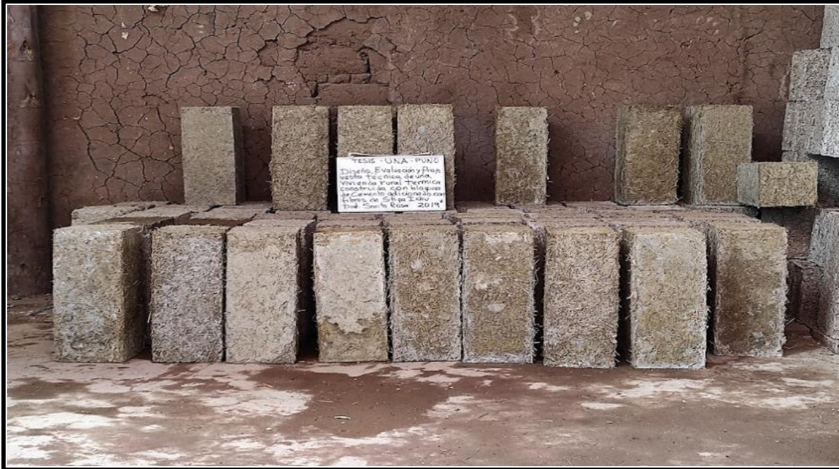
Fotografía 25. VISTA DEL SECADO DE LOS BLOQUES
