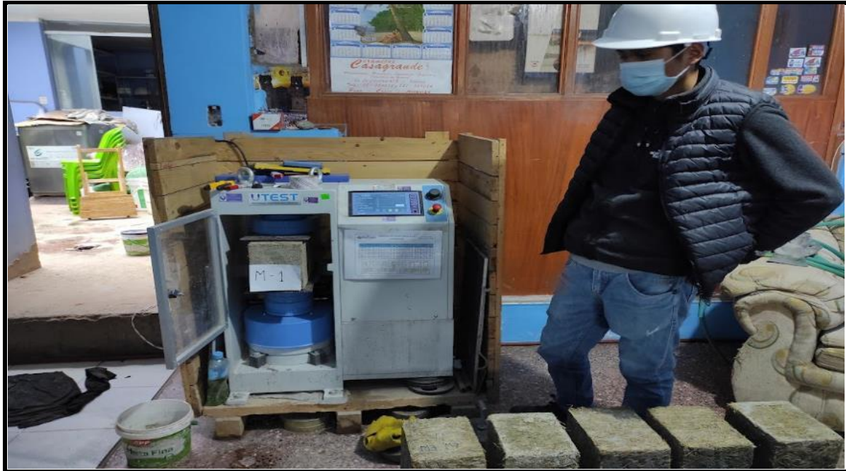
Fotografía 31. VISTA DE MUESTRAS PARA ENSAYO A COMPRESION
