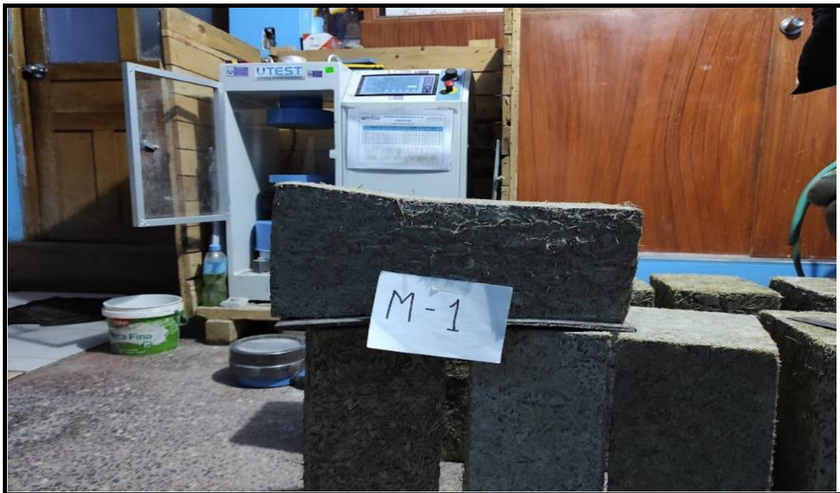
Fotografía 32. VISTA DE LA MUESTRA DESPUES DE LA COMPRESION
