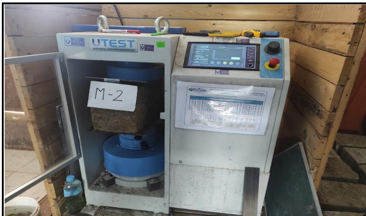
Fotografía 34. VISTA DEL ENSAYO A LA COMPRESION
