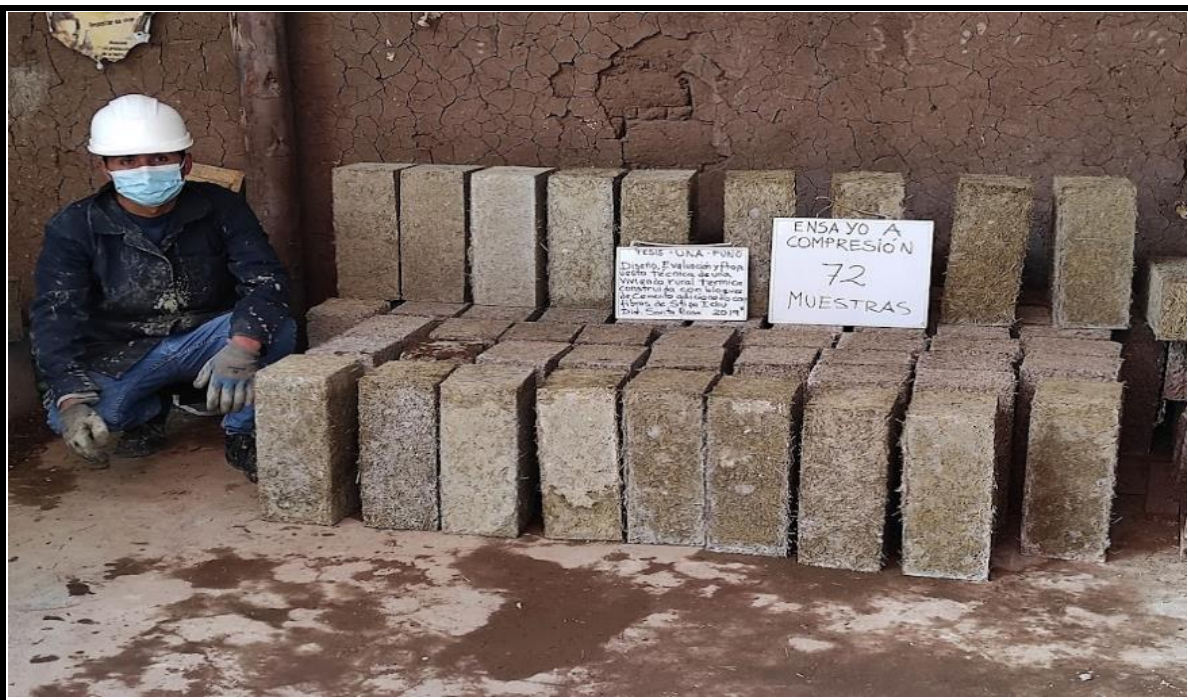
Fotografía 24. VISTA DEL SECADO DE LOS BLOQUES
