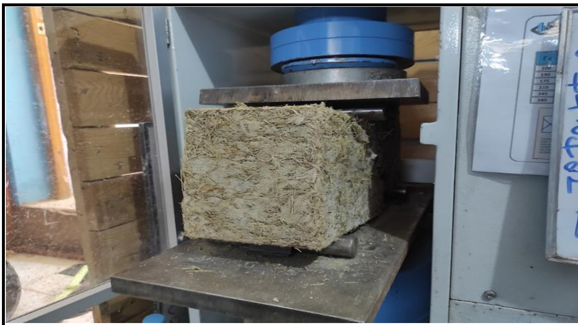
Fotografía 41. VISTA DEL BLOQUE DESPUES DE SER ENSAYADA
