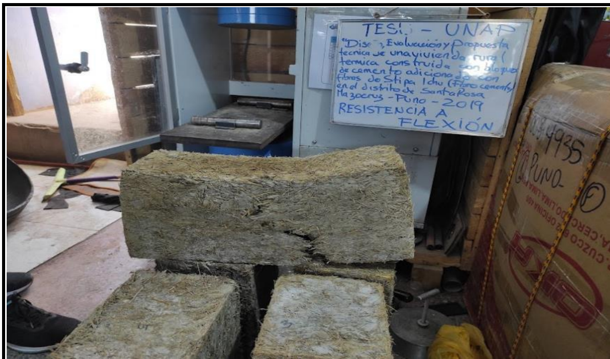
Fotografía 42 . VISTA DEL BLOQUE DESPUES DEL ENSAYO A FLEXION
