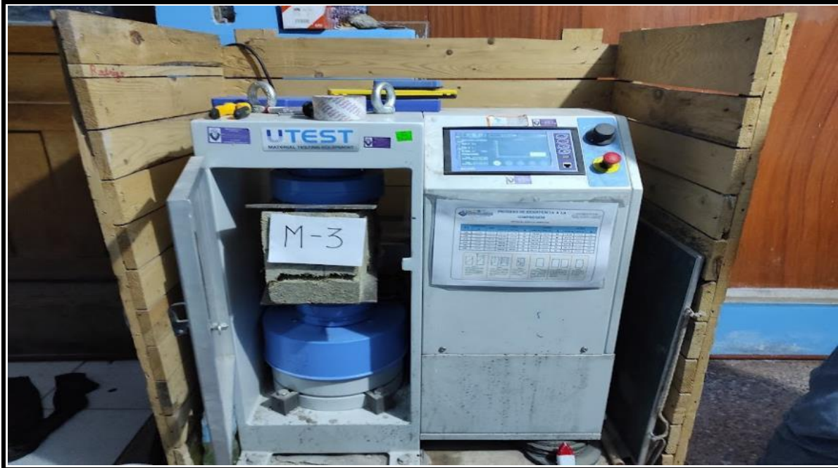
Fotografía 35. VISTA DEL BLOQUE DESPUES DE LA COMPRESION
