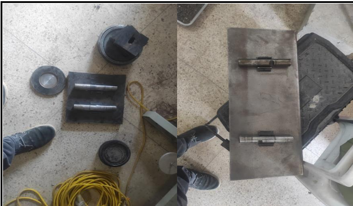
Fotografía 36. VISTA DE LAS PLANCHAS SUPERIOR E INFERIOS PARA EL ENSAYO A FLEXION
