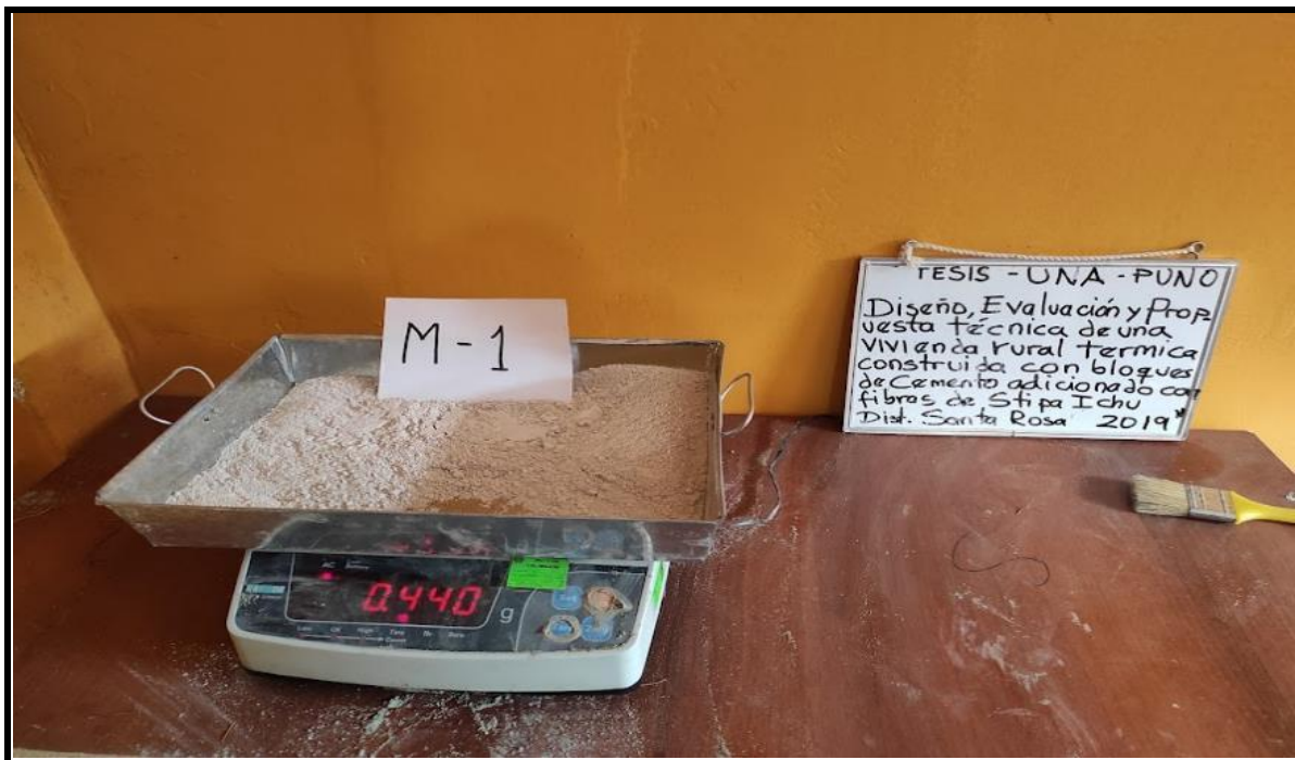
Fotografía 14. VISTA DEL PESADO DE LA CAL
