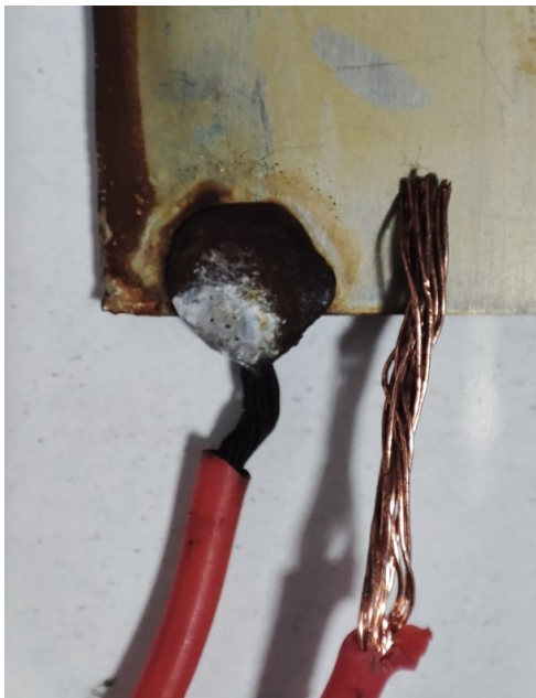
Comparación del cable de cobre utilizado en el electrodo y un cable sin uso
