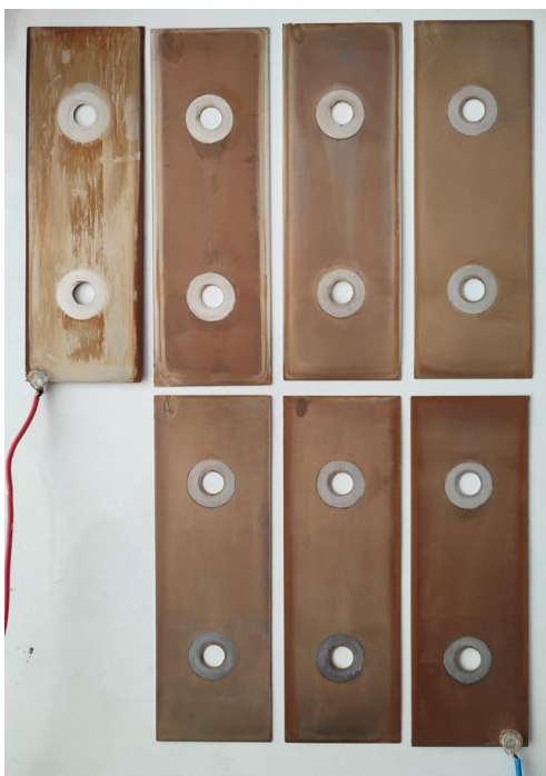
Celdas electrolíticas a las 148 horas de uso
