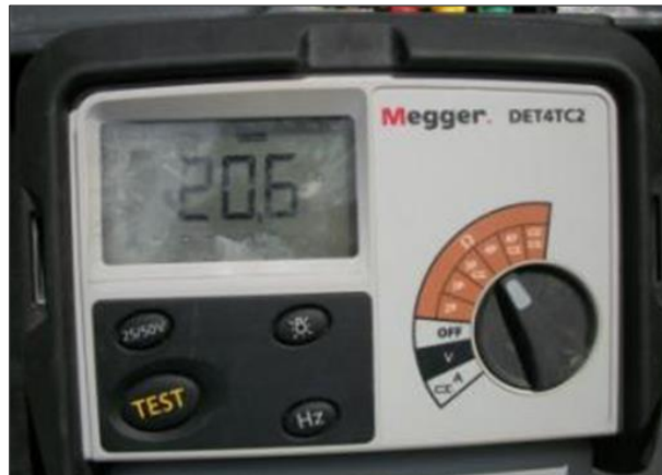
Figura N° 15: Medidor digital, MEGGER Modelo DET4TC2.
