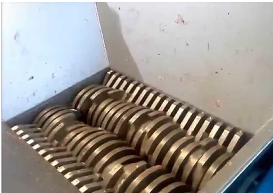
Fotografía 8. Equipo de molienda para la formación de pasta cruda de pescado.
