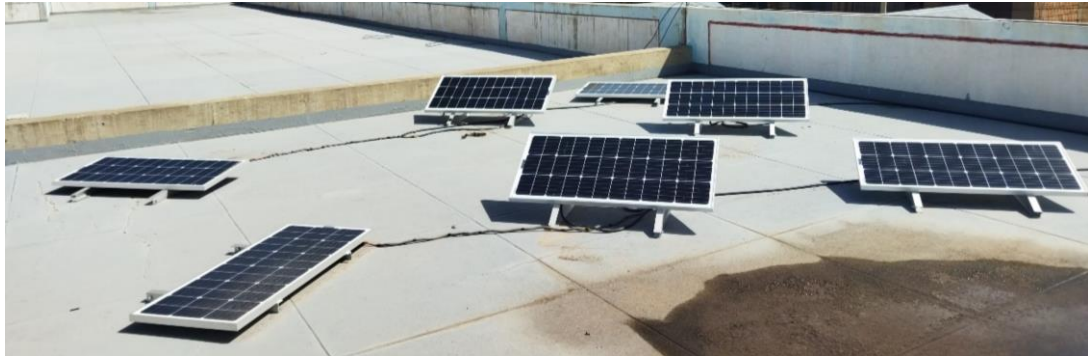
Figura 8. Sistema de medición fotovoltaica a diferentes ángulos de inclinación
