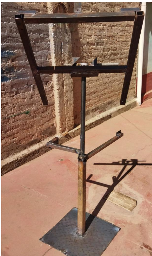
Estructura mecánica del seguidor solar.
