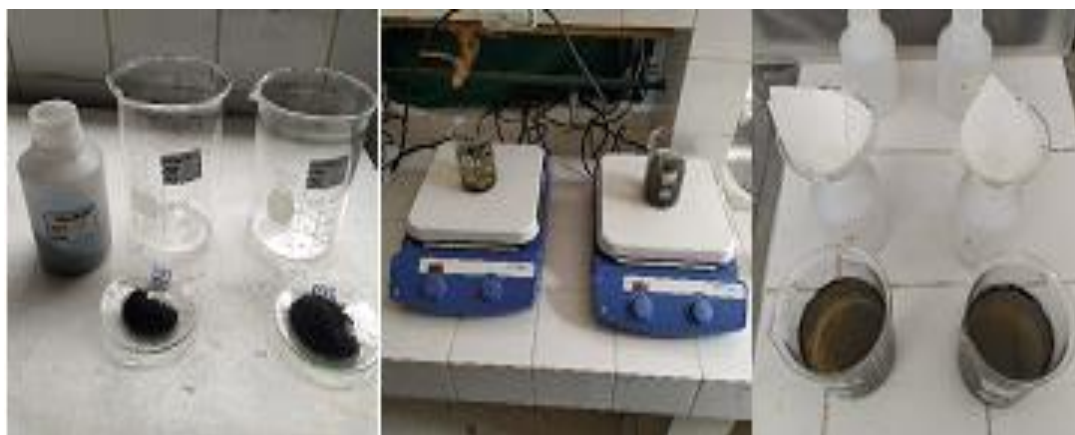
Figura 15. Sistema batch, proceso de bioadsorción de As y Pb
