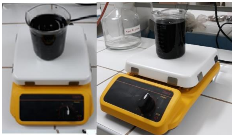
Figura 13. Impregnación con H_3PO_4
