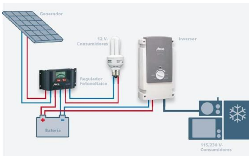
Figura 20: Sistema fotovoltaico aislado
