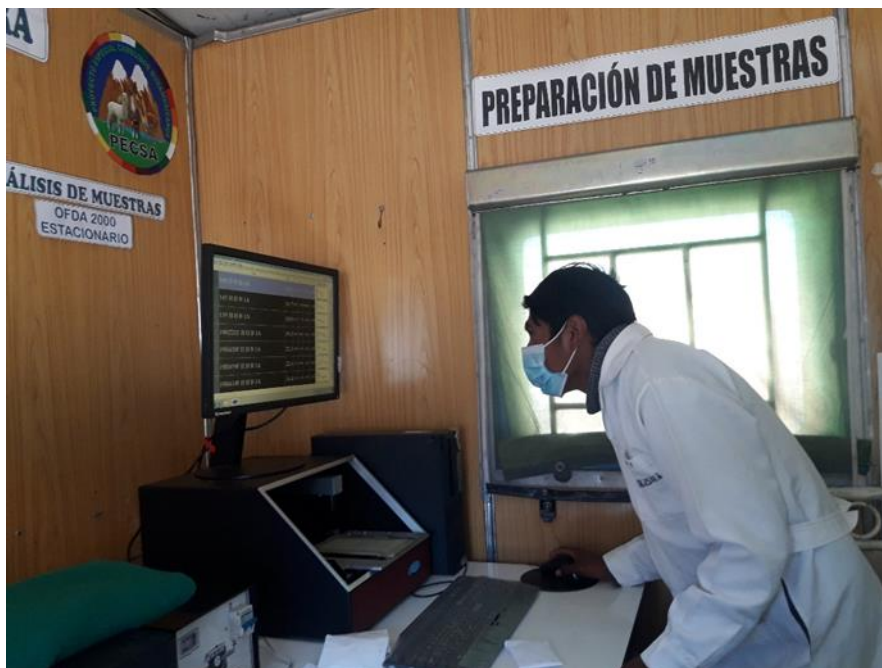
Figura 12. Calibración del equipo OFDA con el slide usando patrones de fibra de poliéster estándar para fibra de alpaca.
