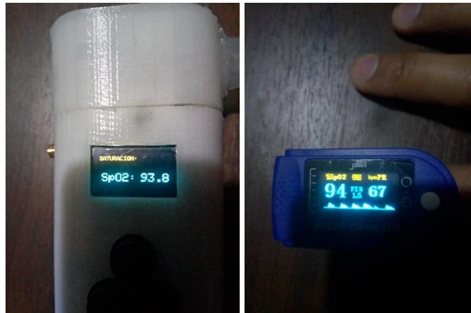
Figura 43: Pruebas de calibración oxímetro
