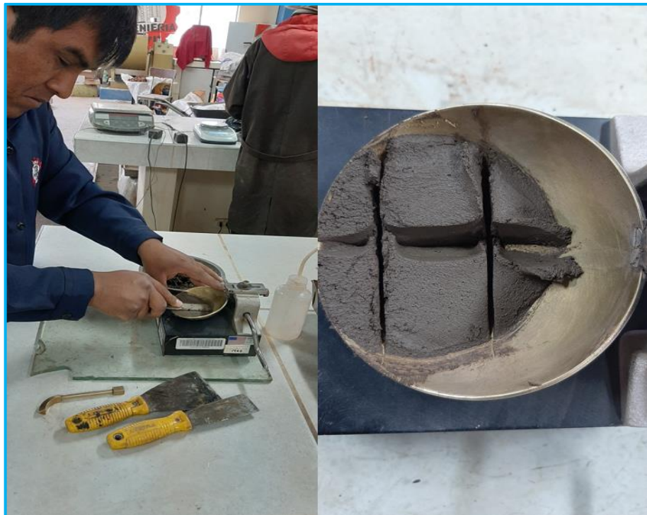
Figura 31. Determinación del límite líquido en el laboratorio de Mecánica de Suelos
