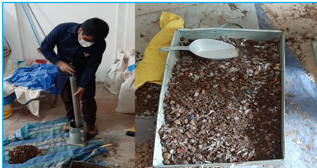
Figura 25. Suelo granular de la cantera salcedo para su compactado de 5 capas
