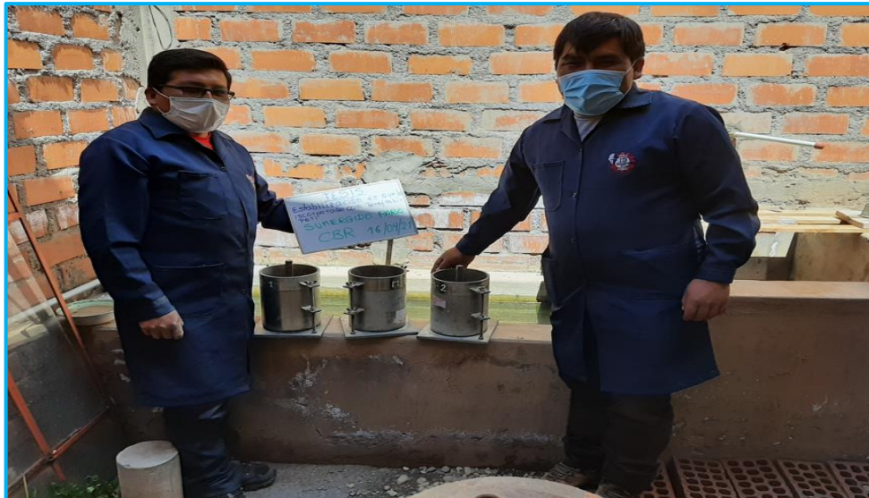
Figura 27. Sumergido de moldes con su muestra de suelo en agua para control de su deformación
