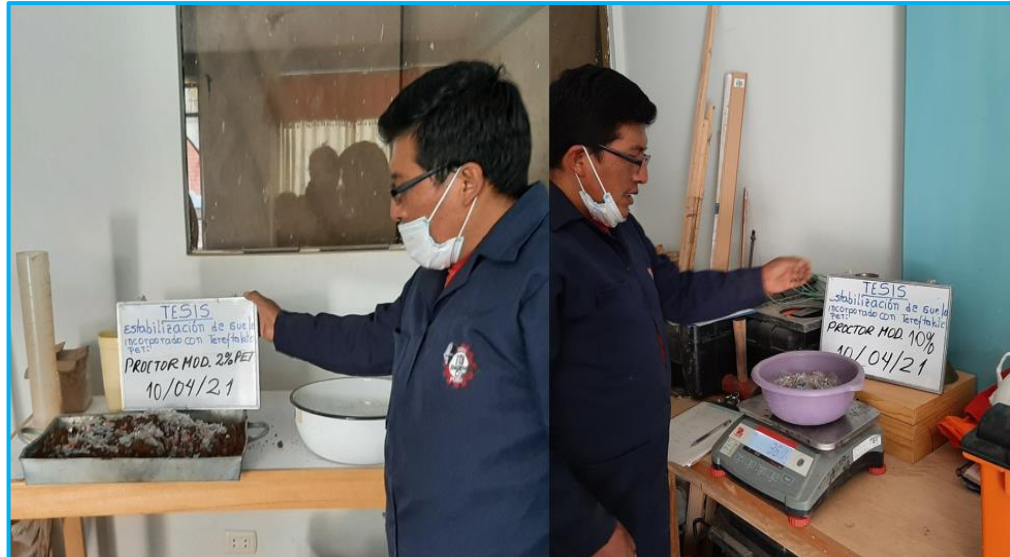
Figura 24. Ensayo de Proctor Modificado con dosificación de PET al 2% y 10%, en el suelo granular de la Cantera de Salcedo
