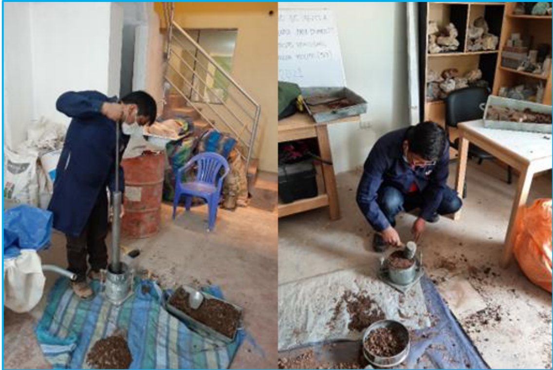
Figura 23. Compactación de suelo granular de la cantera Salcedo distribuida en 5 capas
