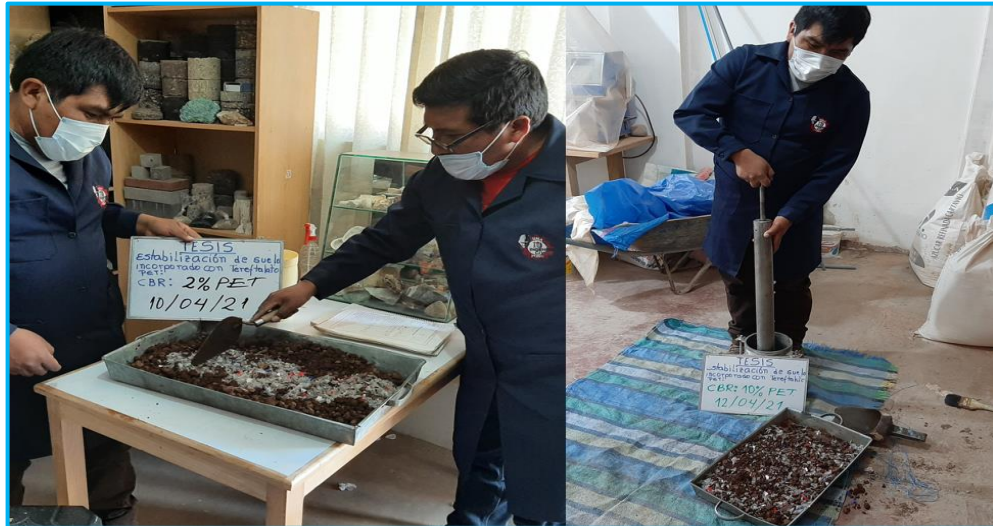
Figura 28. Ensayo de CBR con adición de PET al 2% y 10%, en el suelo granular de la Cantera de Salcedo
