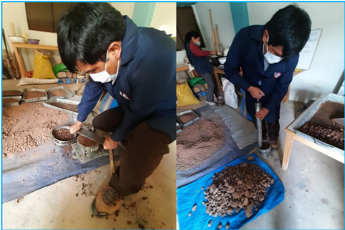
Figura 26. CBR a 12, 25 y 56 golpes enrazados de la muestra de suelo de cantera Salcedo
