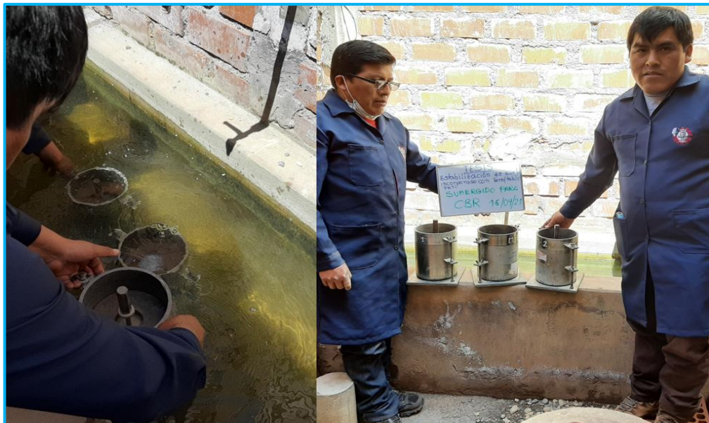
Figura 29. Sumergido de muestra de suelo con adición de PET para su control de deformación
