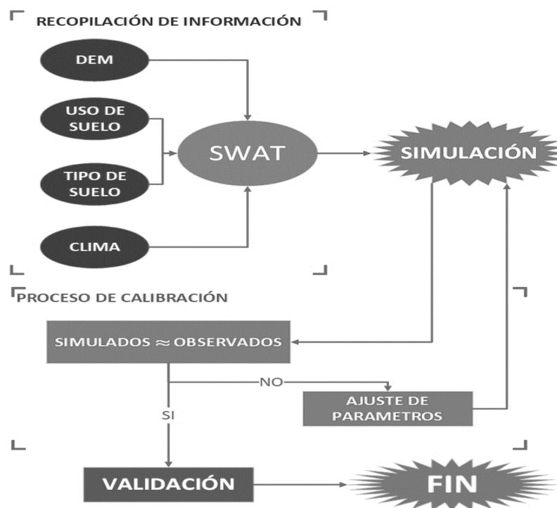
**Figura 9.** Diagrama del proceso de modelización con SWAT
