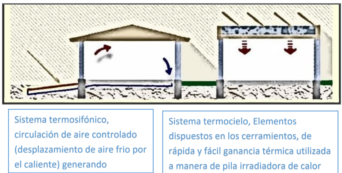
Figura 30. El sistema “termocielo”
