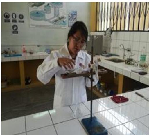
**Figura 19.** Proceso de filtración con cada muestra del proceso de adsorción de Cu
