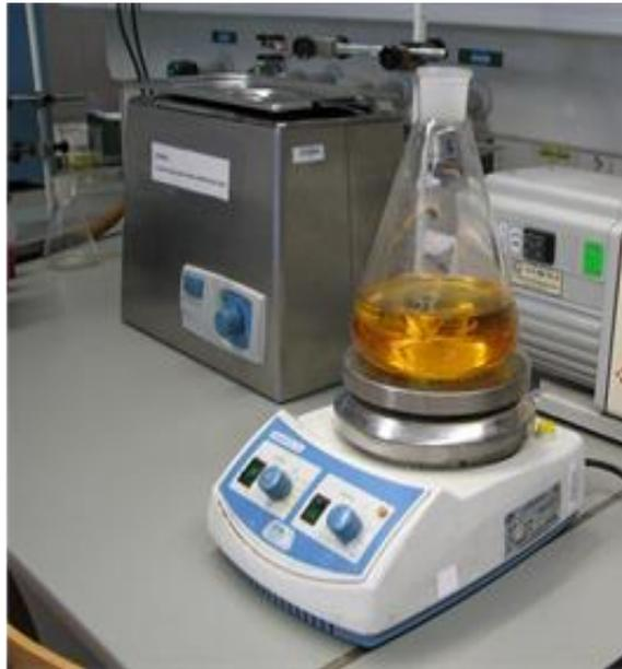
*Figura 2.* Agitador magnético
