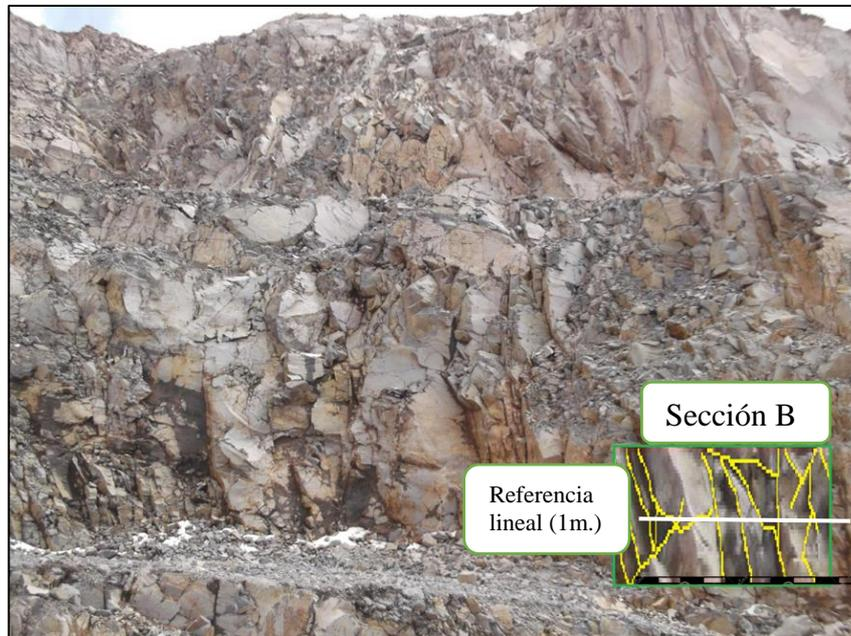
Para aplicar la ecuación de Hudson (1976) en la sección B se contó el número de fracturas en 1 metro lineal y posteriormente se calculó el espaciamiento promedio de las fracturas que interceptan a la línea de referencia como se observa en la figura 5, obteniendo los siguientes resultados:
