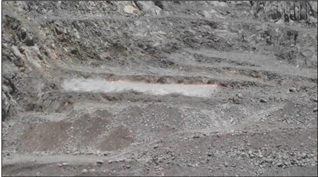
Nota: Secuencia de iniciación fila por fila, voladura diseñada con la nueva malla de perforación y voladura.
