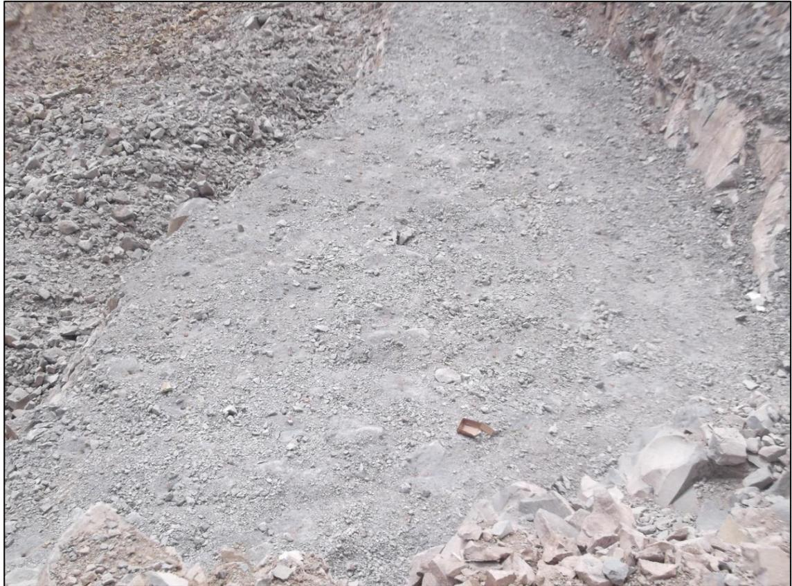
Nota: Taladros cargados con factor de carga 0.31 Kg/m<sup>3</sup>. Distribuidos con el nuevo diseño de malla de voladura.
