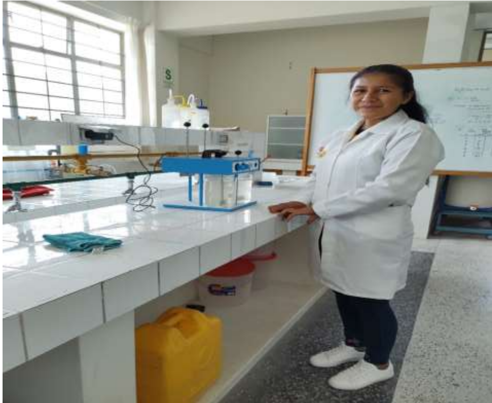
FIGURA F.4. Coagulación y floculación en el equipo de test jar.
