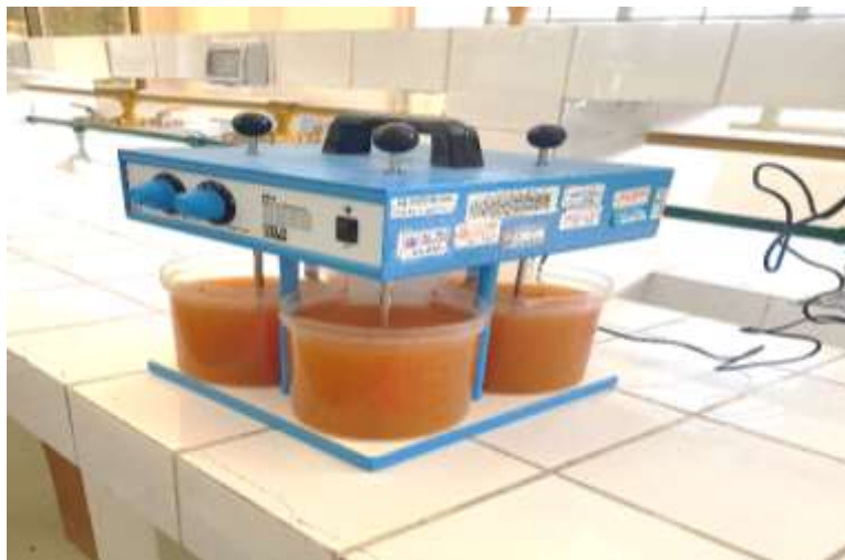
Figura 5. Equipo para ensayo de test de jarras de cuatro jarras
