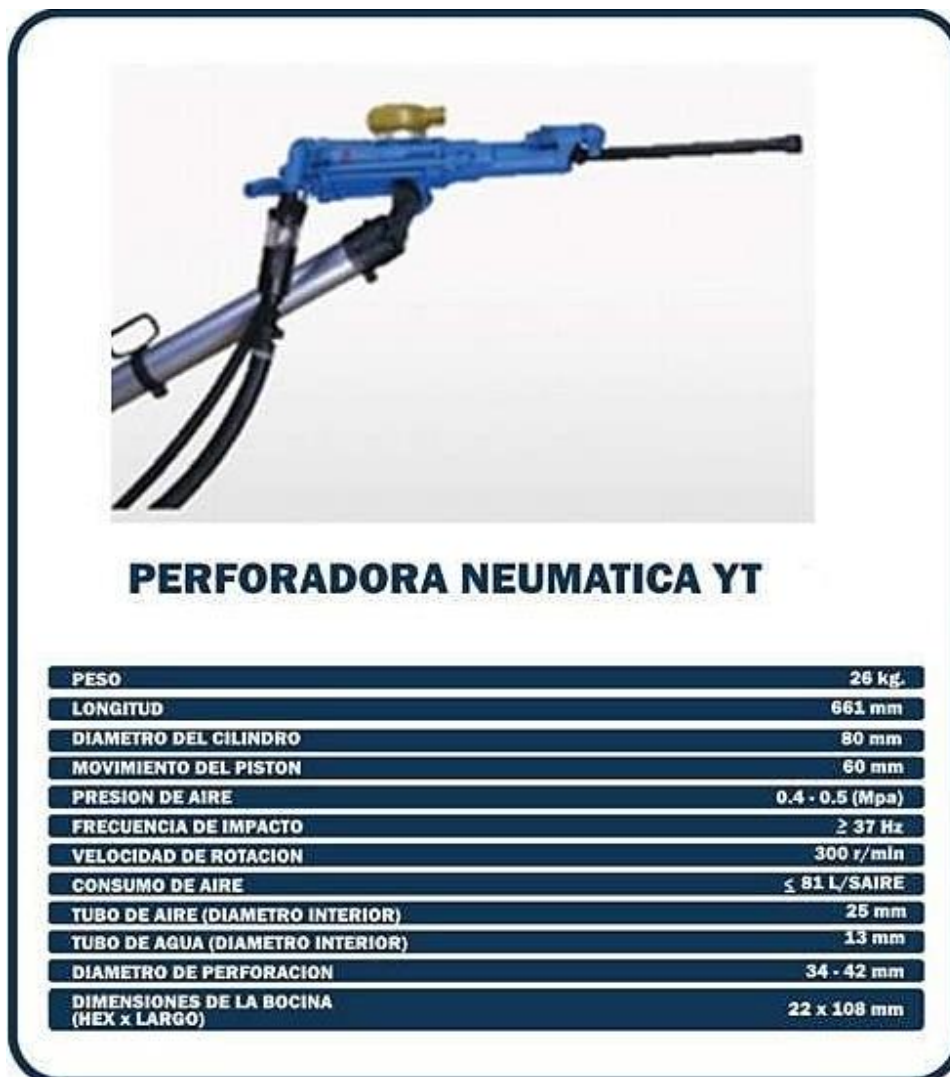
Figura 1. Características de la perforadora neumática YT.
