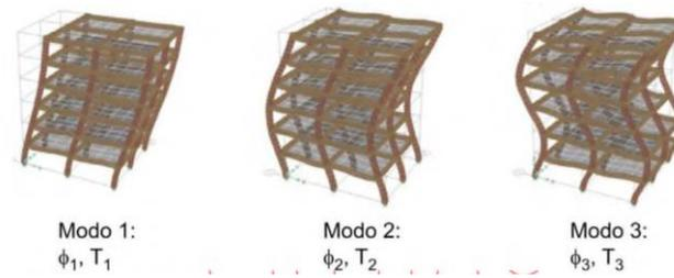
**Figura 19:** Modos de vibración traslacional de un edificio de seis pisos.
