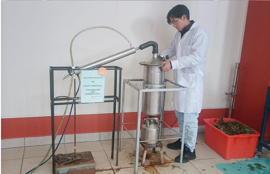
B 4. Cargado de la muestra al equipo de extracción de aceites esenciales.
