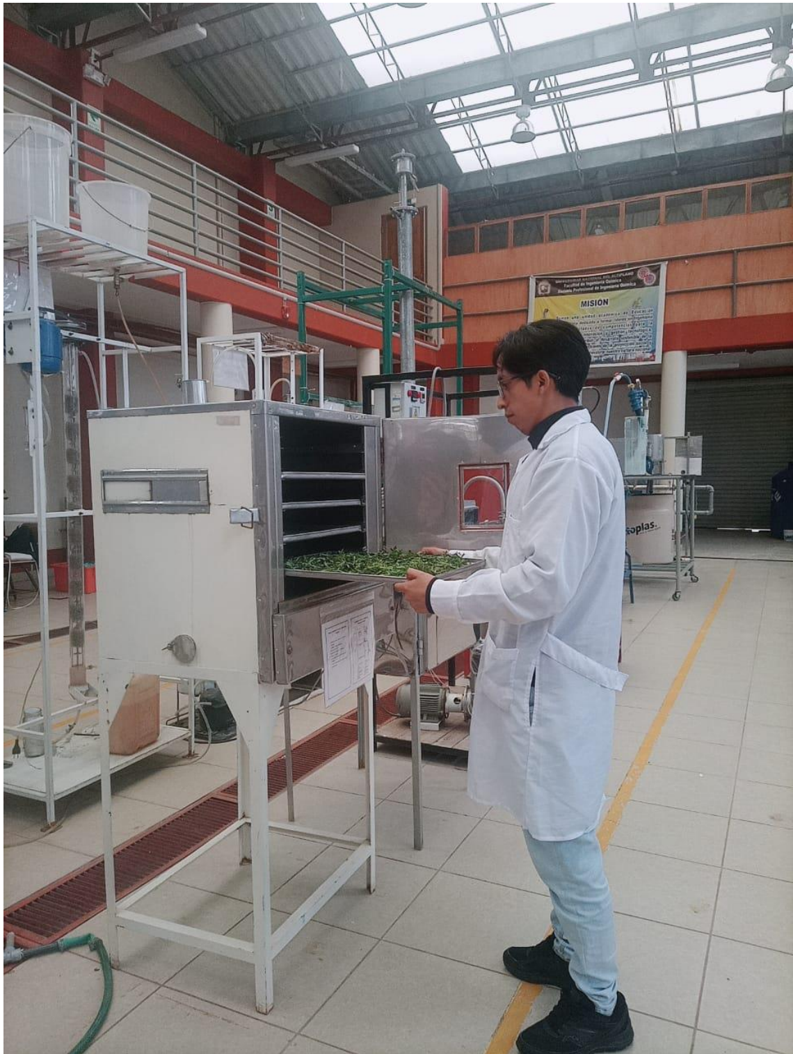
B 3. Secado de la materia prima en un secador por convección forzada.
