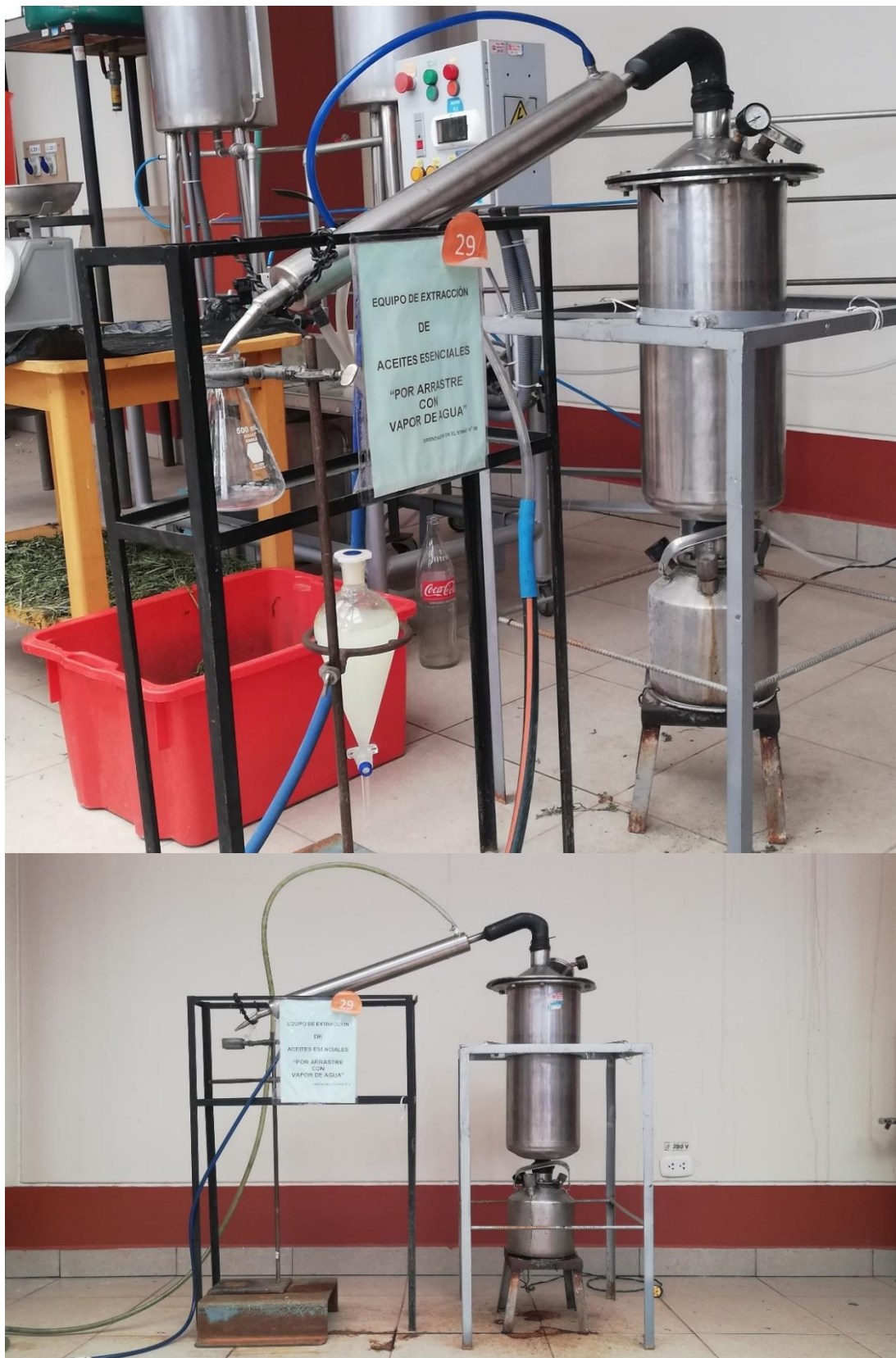
B 1. Equipo de extracción de aceites esenciales “Por arrastre de vapor de agua”.
