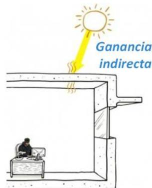
**Figura 2.5:** *Captación indirecta a través de muros y techos.*
