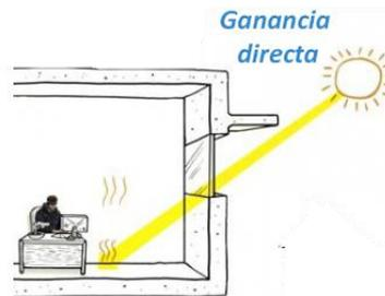
**Figura 2.4:** *Captación directa a través de aperturas integradas.*
