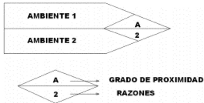
**Figura 3.** Esquema de interrelación de funciones.
