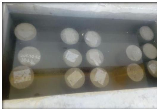
**Figura 7.** Curado de testigos de concreto
