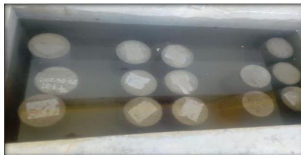
**Figura 15.** Curado de las muestras de concreto
