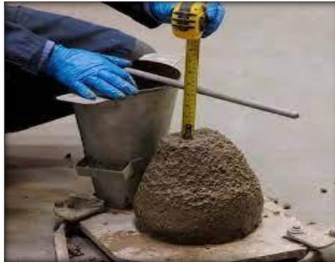
**Figura 8.** Ensayo de asentamiento (cono de Abrams)
