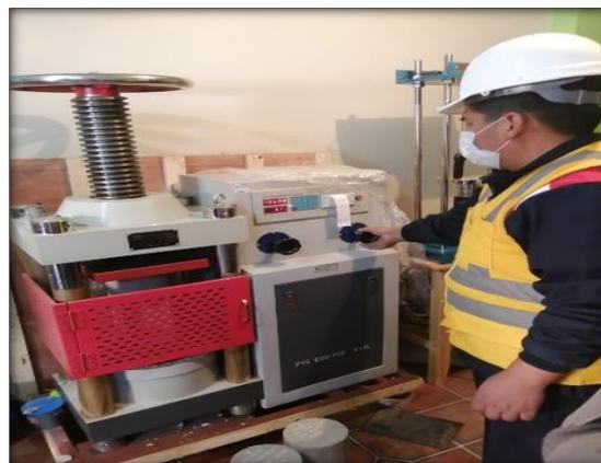
**Figura 16.** Ensayo a la compresión axial
