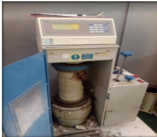
**Figura 9.** Ensayo a la compresión axial
