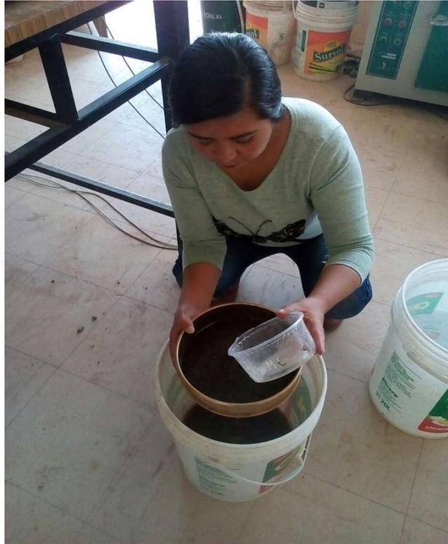
**Fotografía 05.** *Lavando del material para eliminar impurezas.*
