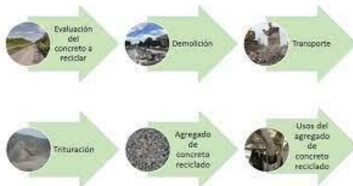
**Figura 2.** Procedimiento del agregado reciclado
