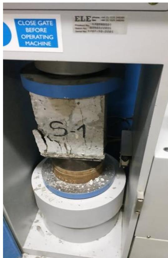
**Fotografía 22.** *Falla provocada a la bloqueta de concreto producto de la prueba de resistencia a la compresión.*
