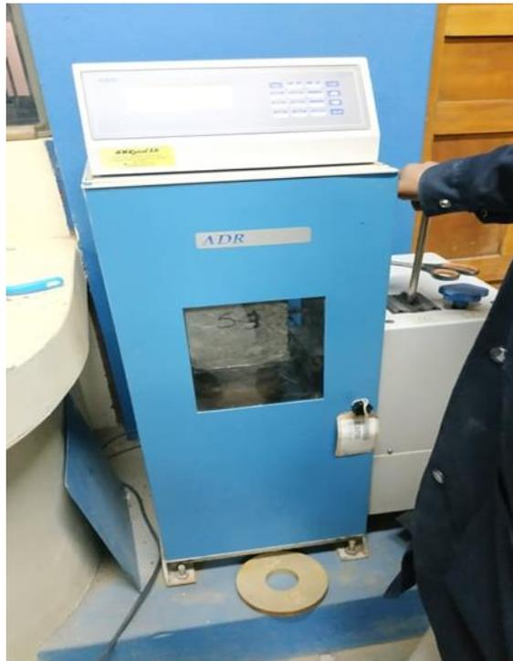
**Fotografía 21.** *Ensayo a la compresión.*
