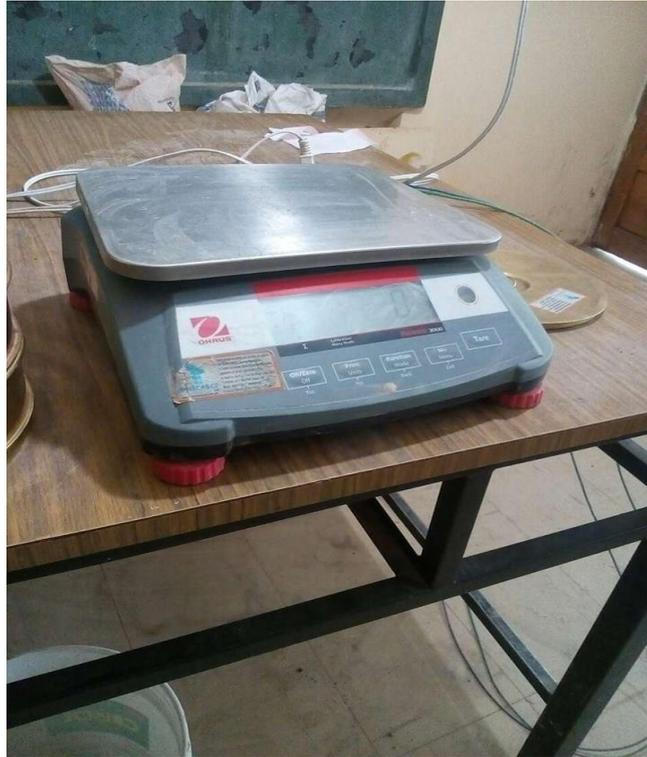
**Fotografía 07.** Balanza para pesar el agregado.
