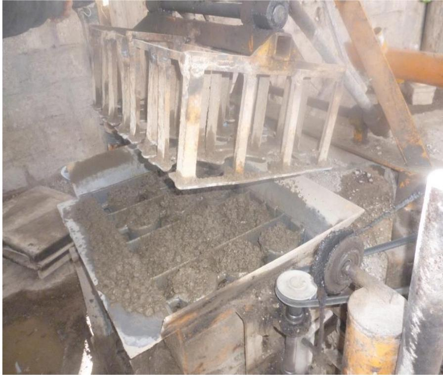
**Fotografía 11.** *Colocación de la mezcla a la bloquetera.*
