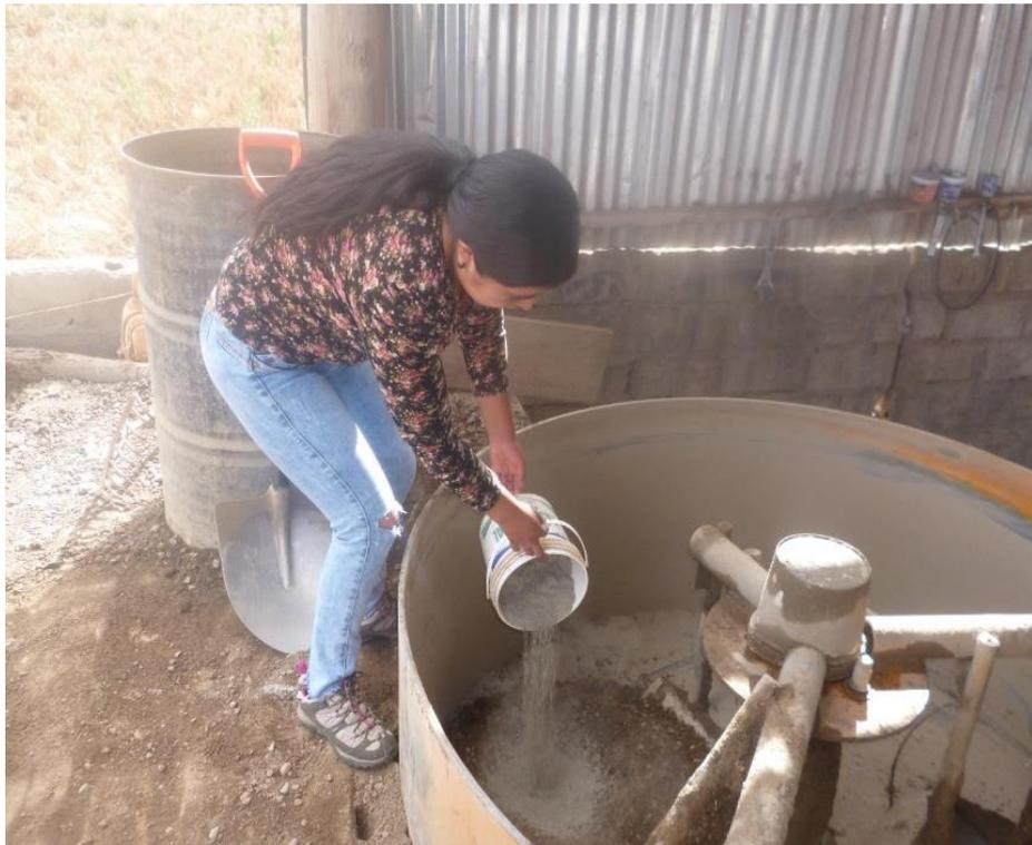
**Fotografía 09.** *Agregando a la mezcla un porcentaje adicional del 5%.10% y 20% del cemento.*
