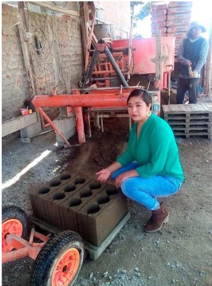
**Fotografía 14.** *Bloquetas con el 5% de cemento adicionado.*
