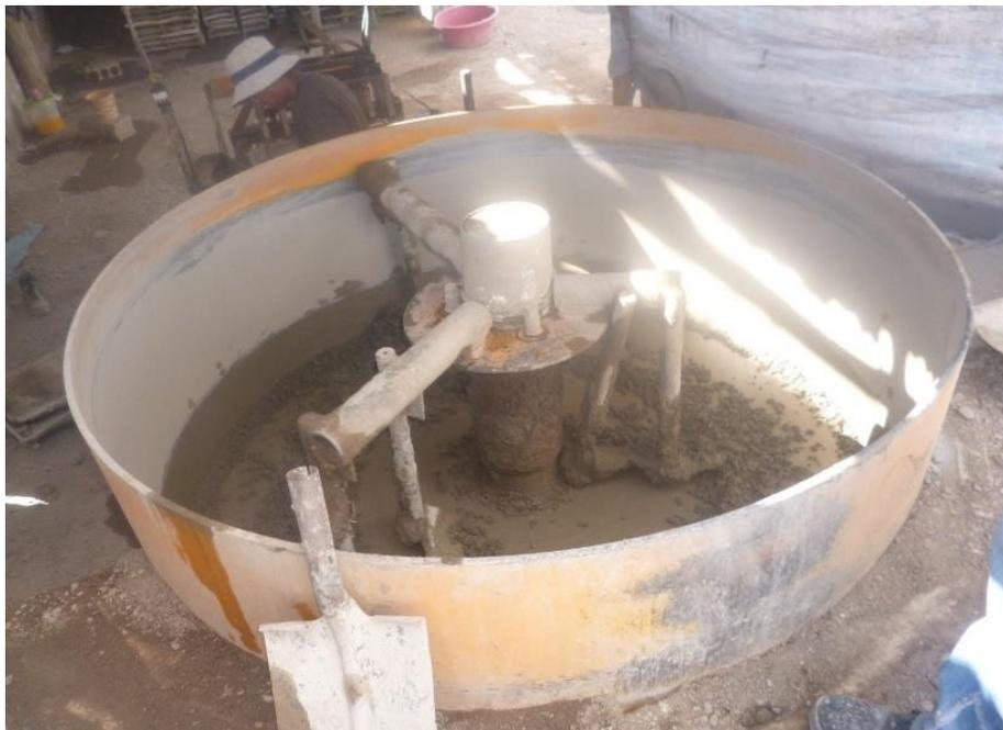
**Fotografía 10.** *Consistencia húmeda de la mezcla.*
