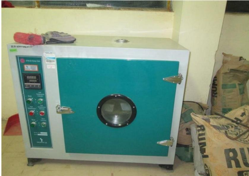
**Fotografía 13.** *Muestra de horno de laboratorio.*
