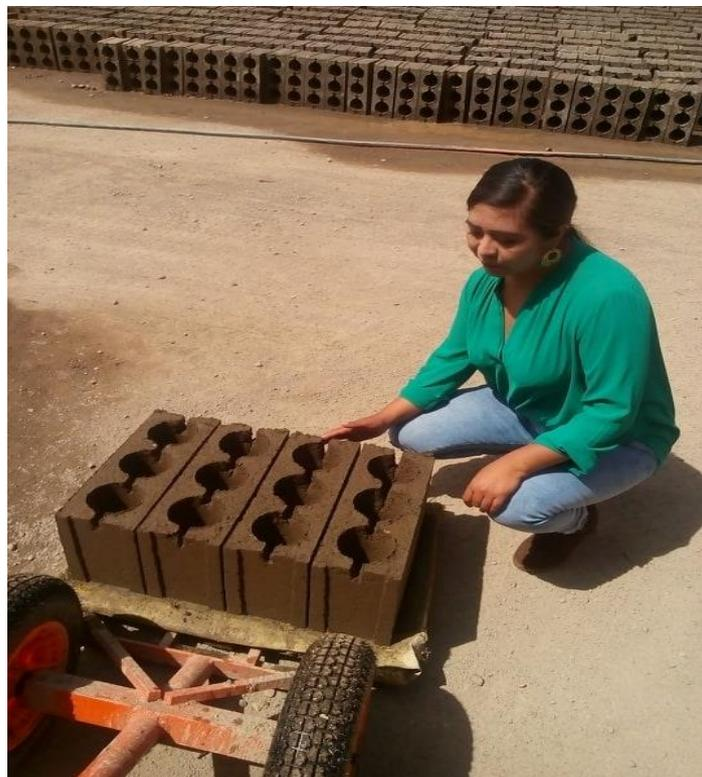
**Fotografía 16.** *Bloquetas con el 20% de cemento adicionado.*
