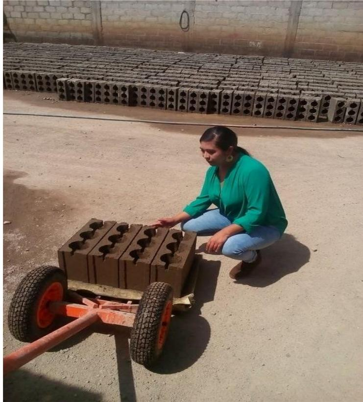
**Fotografía 15.** *Bloquetas con el 10% de cemento adicionado.*
