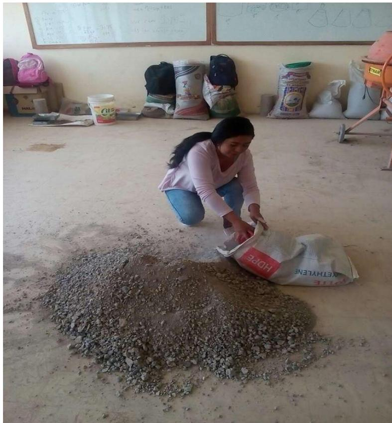
**Fotografía 08.** Agregado reciclado para la elaboración de las bloquetas.
