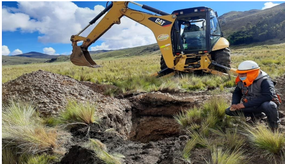
Figura 15. Exploración de calicatas a cielo abierto en cantera Carimayo.
