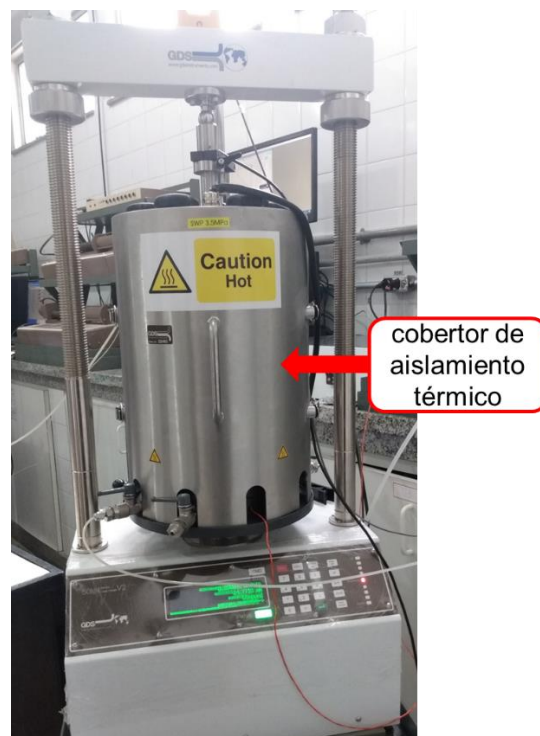
Figura 0.10 Cobertor de aislamiento térmico del triaxial térmico.
