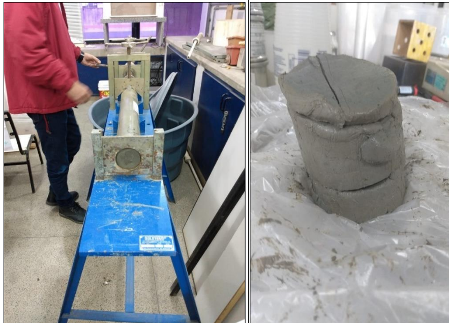
Figura 0.2 Extracción de las muestras de los tubos Shelby.
