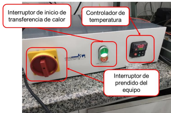
Figura 0.12 Equipo de control de temperatura.
