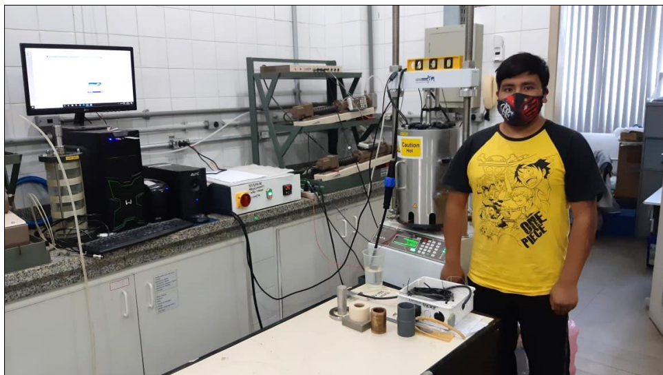
Figura 0.13 Equipo triaxial térmico con todas sus partes.
