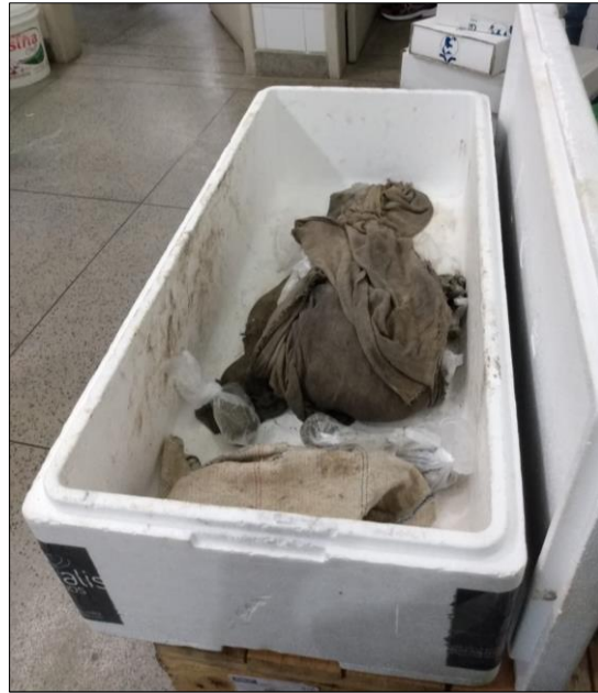
Figura 0.3 Muestra homogeneizada y guardada en un recipiente de tecnopor.
