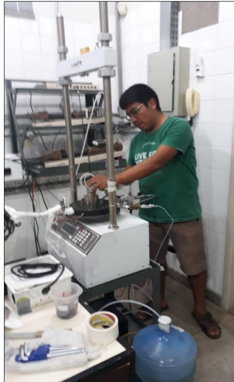
Figura 0.16 Saturación del equipo triaxial.
