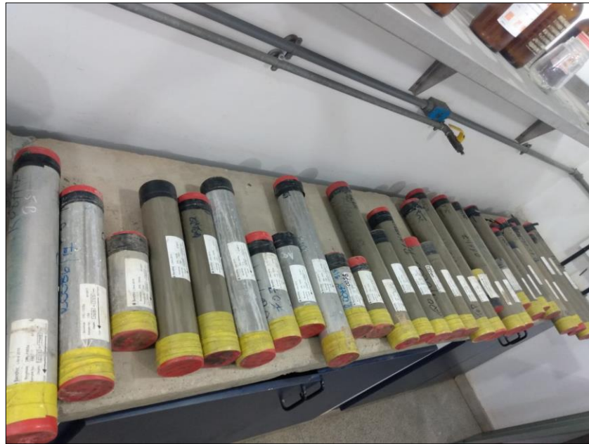
Figura 0.1 Muestra recolectada por muestreadores tipo Shelby.
