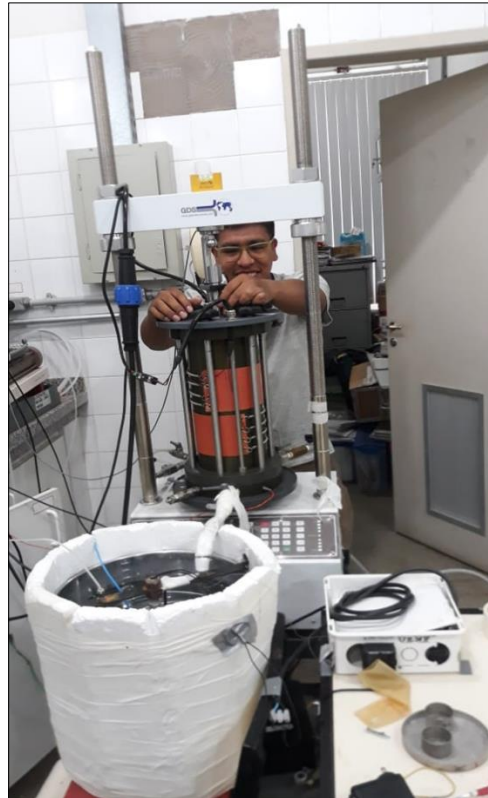
Figura 0.17 Instalación de la celda triaxial térmica.
