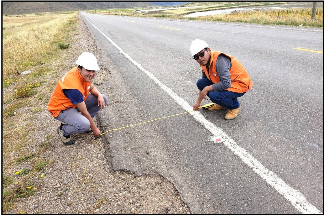
Figura 8: Medición de ancho de berma
