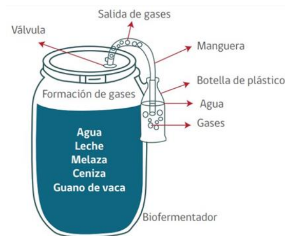
Figura 3. Biodigestor para la obtención del biol
