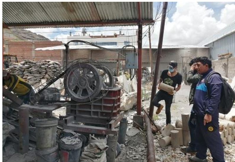
Figura 9. Colocado de probetas en la trituradora tipo mandíbula
