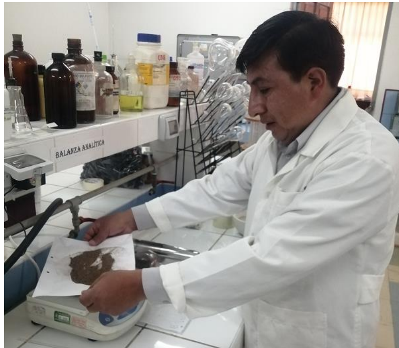
Figura 36. Ensayo de material fino por debajo de la malla 200
