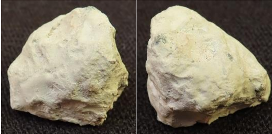
Figura 12. Agregado reciclado impregnado con cemento IP
