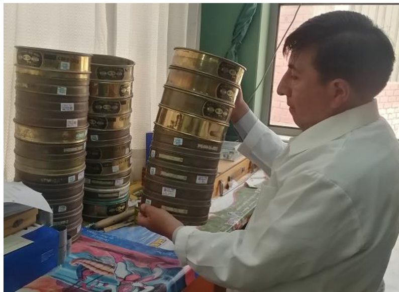
Figura 35. Análisis granulométrico del agregado grueso
