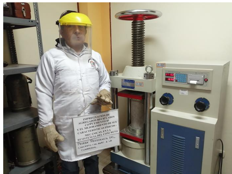
Figura 6. Prueba de resistencia a la compresión
