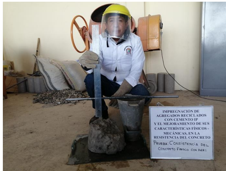
Figura 4. Prueba de asentamiento del concreto
