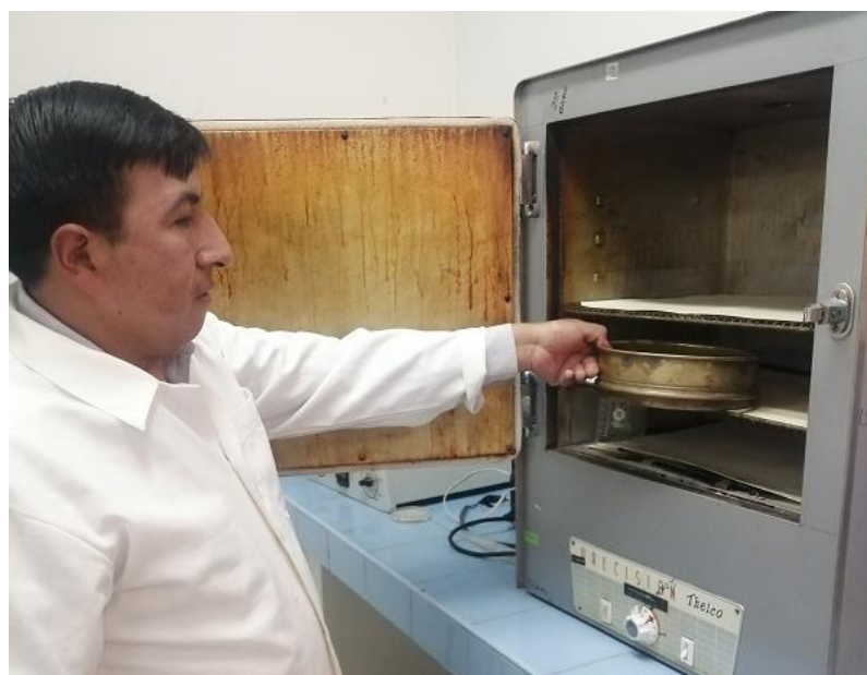
Figura 37. Secado de agregado grueso impregnado
