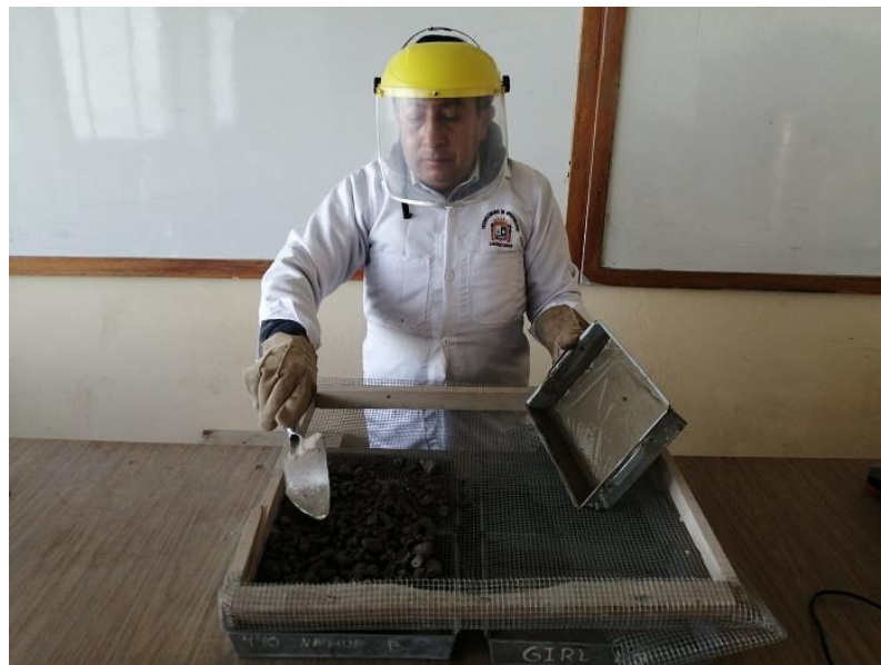
Figura 33. Eliminación de excedente del proceso de impregnación
