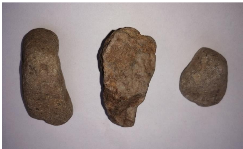
Figura 14. Agregado grueso natural
