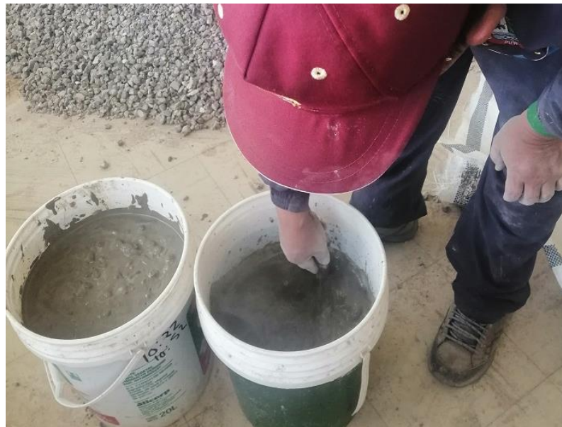
Figura 32. Proceso de impregnación del agregado grueso reciclado con cemento IP
