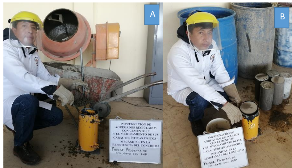
Figura 5. Elaboración de probetas de concreto
