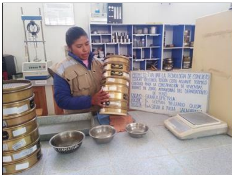
C4. Tamizado de los agregados extraídas de la cantera.
