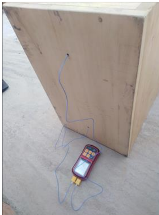
C22. Ubicación de los sensores termopares extremos.
