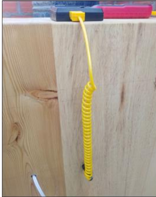
C21. Ubicación intermedia del sensor termopar.
