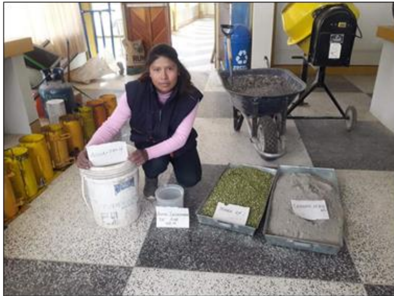
C6. Preparación de materiales con aditivo incorporador de aire y fibra de totora.
