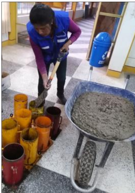
C10. Moldes cilíndricos de concreto testigo (CCT-0%).
