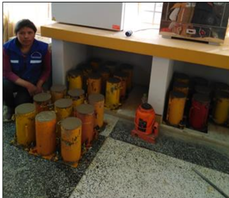
C12. Briquetas vaciadas con concreto, luego desencofrar de 24 horas después del vaciado.
