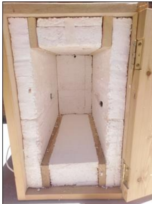
C20. Aislamiento de la caja de prueba interior.
