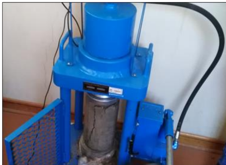
C18. Agrietamiento de la muestra cilíndrico.
