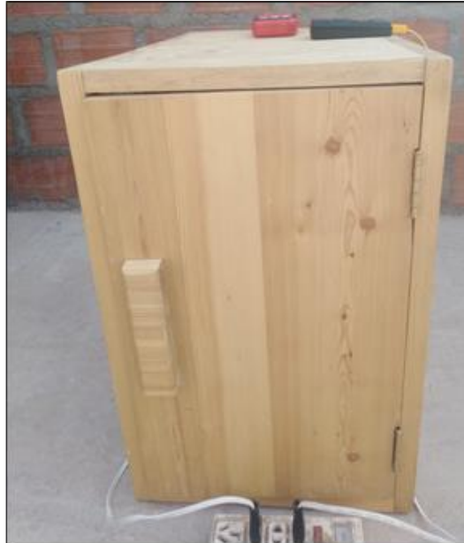
C19. Caja de prueba de conductividad térmica.
