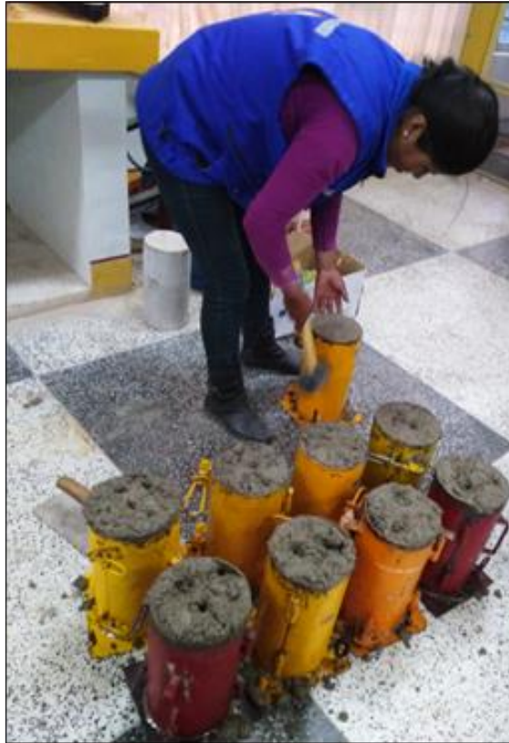
C11. Especímenes colados de concreto testigo (CCT-0%).
