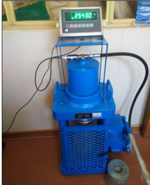
C17. Prueba de compresión de una probeta cilíndrica.
