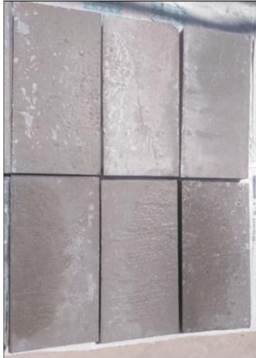
C15. Concreto celular después de haber sido desmoldados.
