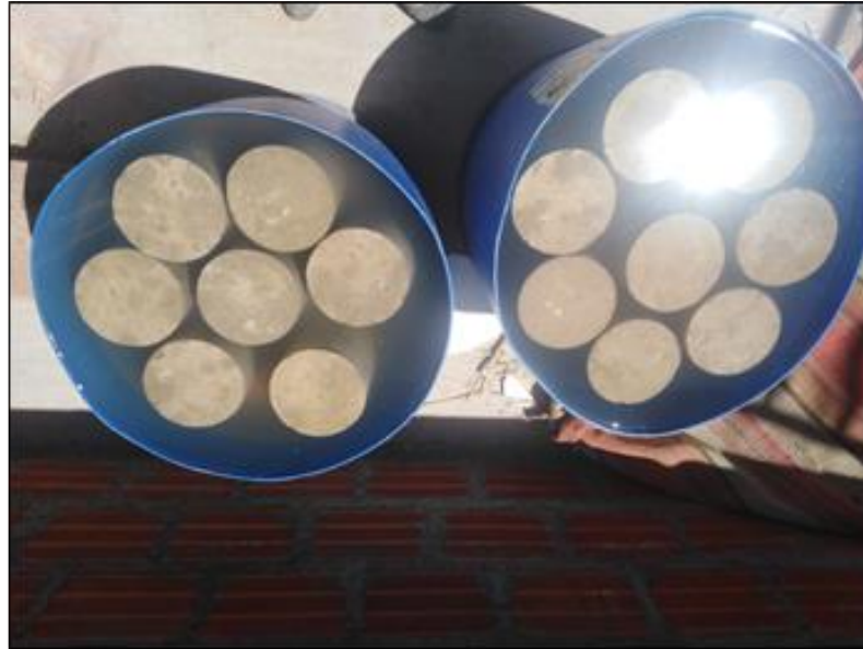
C13. Proceso de curado de concreto celular.
