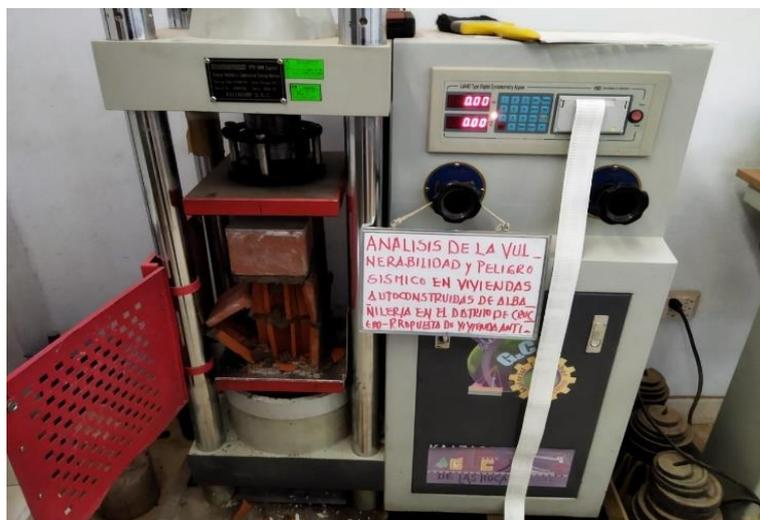
Se realizó el ensayo de resistencia a la compresión de pilas de albañilería (anexo F) llegando a un resultado de resistencia a la compresión de 72.21 kg/cm<sup>2</sup>. Pero la Norma E.070 Albañilería nos indica que la resistencia a compresión 65 kg/cm<sup>2</sup> esto quiere decir que si cumple con la norma.
