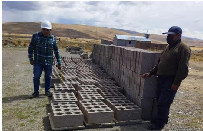
Se realizó el ensayo de resistencia a la compresión de unidades de albañilería del ladrillo King Kong – 18 huecos (anexo F), llegando a una resistencia a compresión de  $128.18 \text{ kg/cm}^2$ , haciendo una comparación con la Norma E.070 Albañilería nos indique que la resistencia a compresión debe de llegar como mínimo a  $145 \text{ kg/cm}^2$  por esta razón podemos deducir no cumple con la norma.
