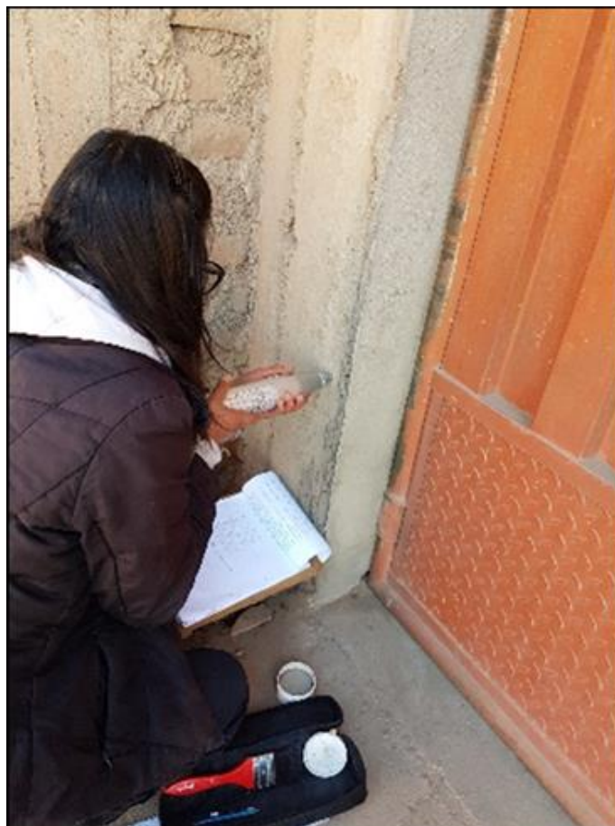
Figura 30. Cuadrilla para el esclerómetro min de 10 puntos en una columna
