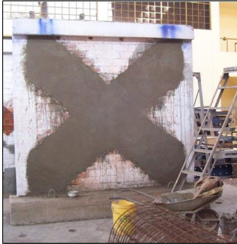
Figura 67: Reforzamiento con bandas de refuerzo.
