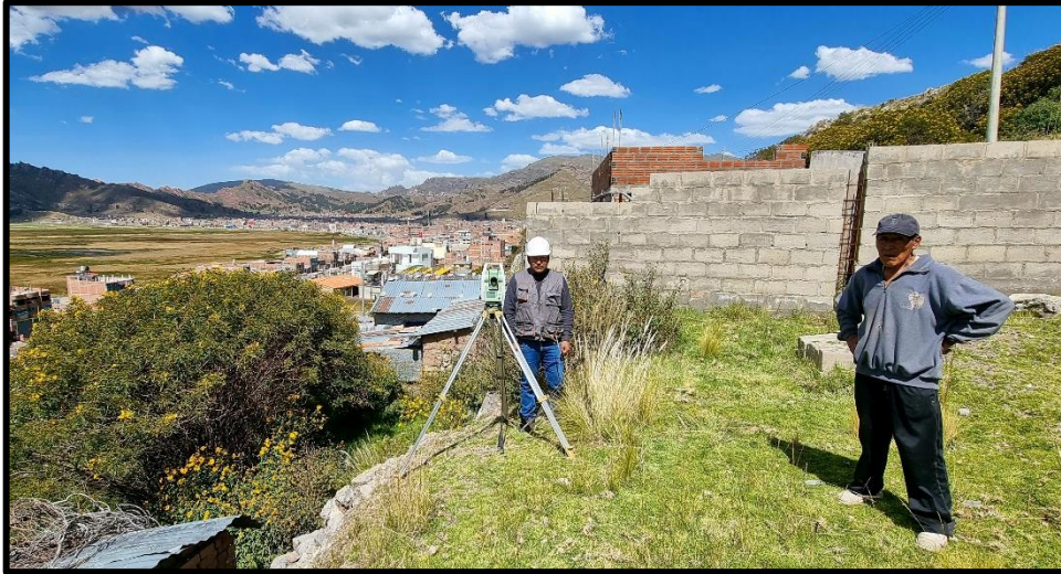
Foto N° 06: Levantamiento con estación total.
