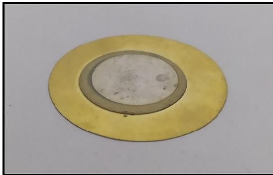
**Figura 1:** Sensor Piezoeléctrico
