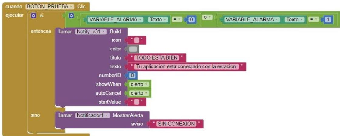
**Figura 53:** Bloques Prueba de conexión con la estación y notificación.
