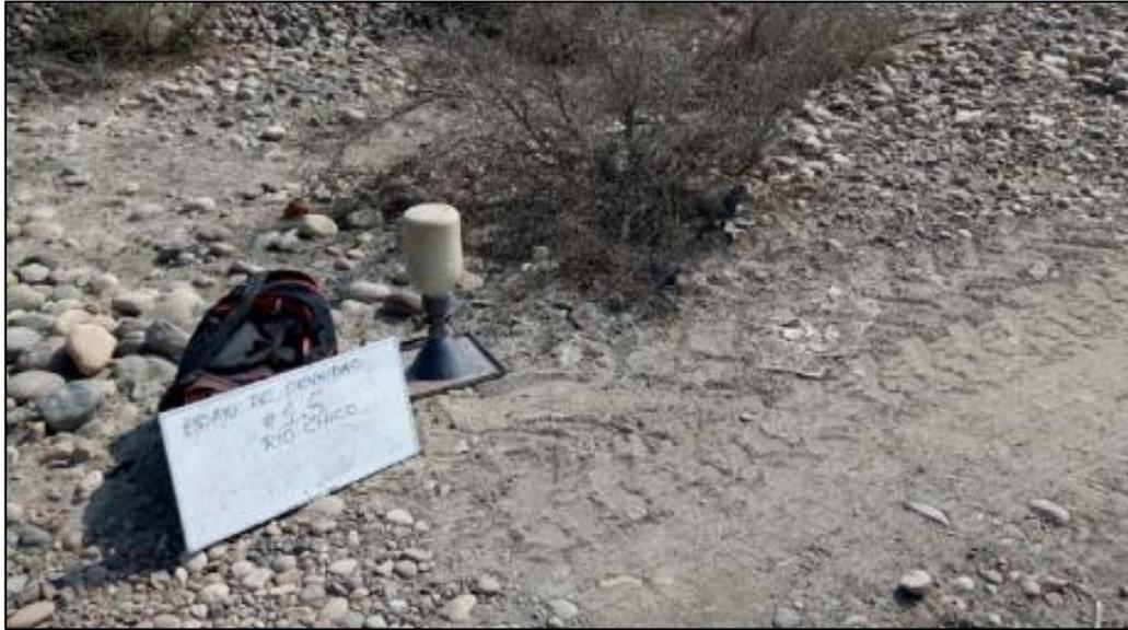
Figura 12. Ensayo de densidad de campo en situ
