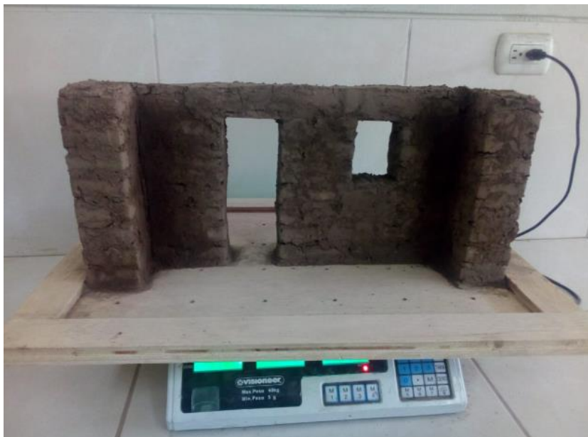
Figura 24. Muro sin refuerzo.
