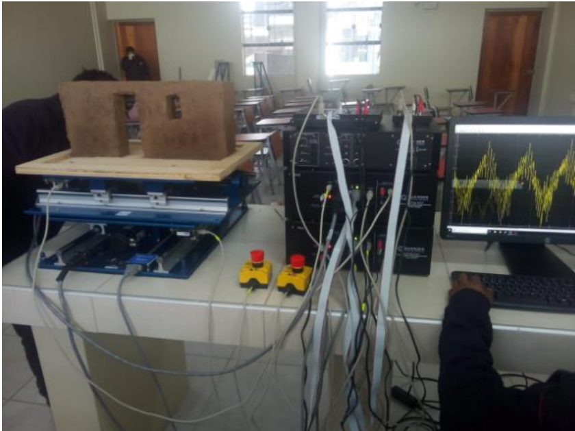
Figura 27. Prototipo ensamblado en la mesa vibratoria.
