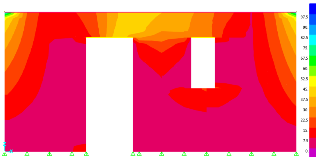
Figura 34. Esfuerzo longitudinal frontal para adobe nuevo.
