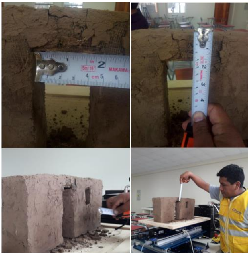
Figura 45. Fallas en el prototipo sin refuerzo con refuerzo.
