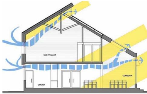
**Figura 5:** Captación directa a través de espacio solar integrado.
