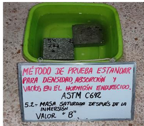
Saturación de Muestra - ASTM-C642
