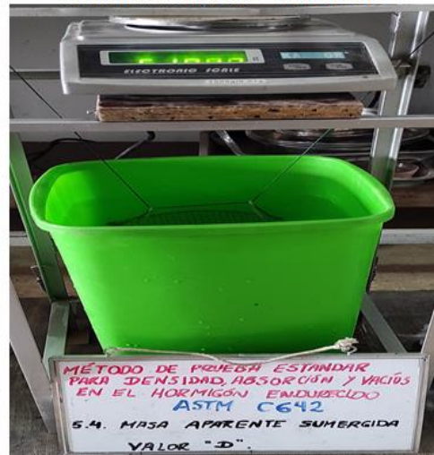
Muestra Sumergida - ASTM-C642
