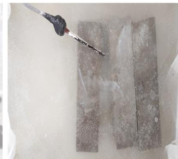
Curado de Probetas y Vigas a 10 °C
