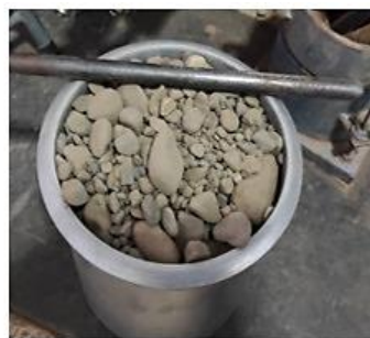
Ensayo de Peso Unitario Suelto y Compactado de los Agregados
