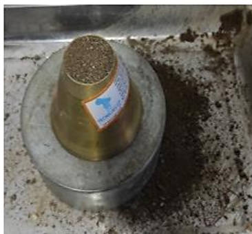
Ensayo para la Gravedad Específica y Absorción del Agregado Fino
