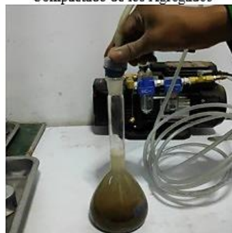
Ensayo de Peso Específico de Agregado Fino (Extracción de Aire)
