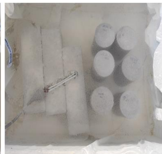
Curado de Probetas y Vigas a 15 °C
