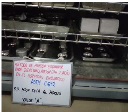
Muestra Secada al Horno - ASTM-C642
