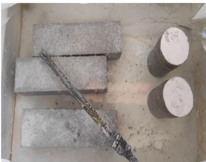
Curado de Probetas y Vigas a 20 °C
