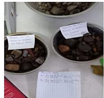
Ensayo de Peso Específico y Absorción de Agregados Gruesos
