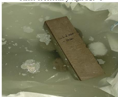
Curado de Probetas y Vigas a 5 °C
