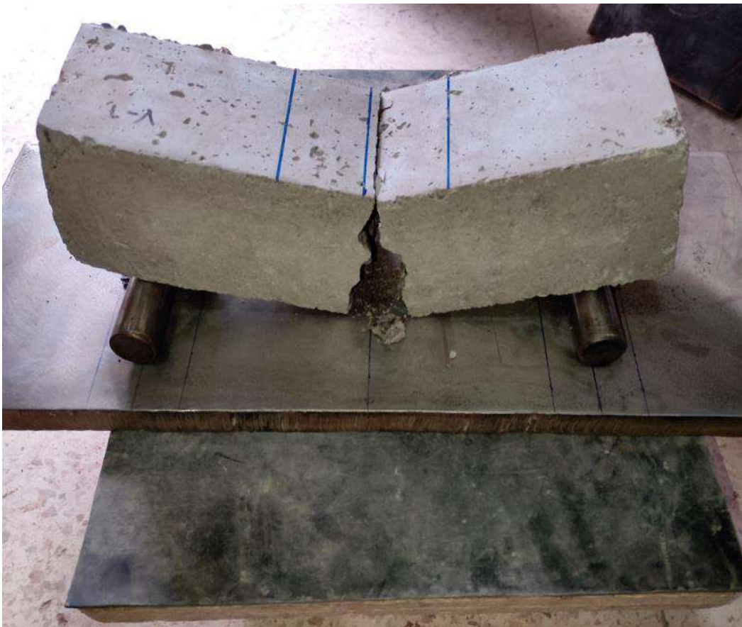
Fotografía 16. "Falla en el tercio central, ensayo a flexión"
