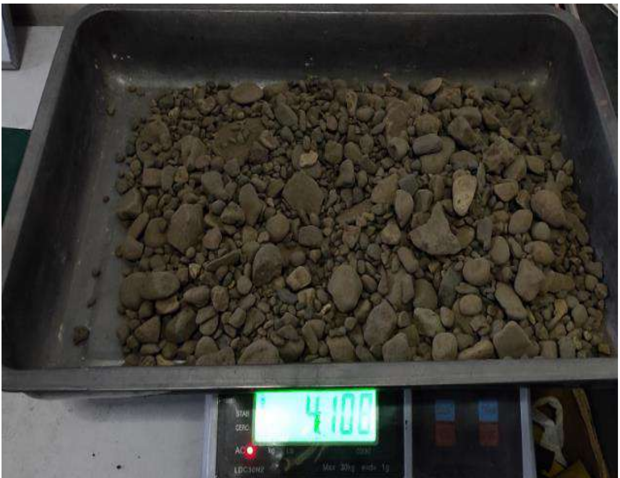
Fotografía 2. "Registro del peso seco de los agregados"
