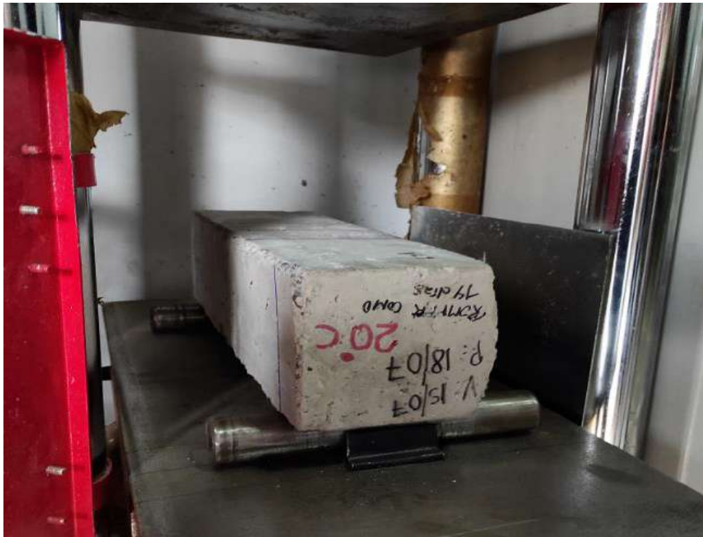
Fotografía 15. "Ensayo a flexión en vigas de concreto"
