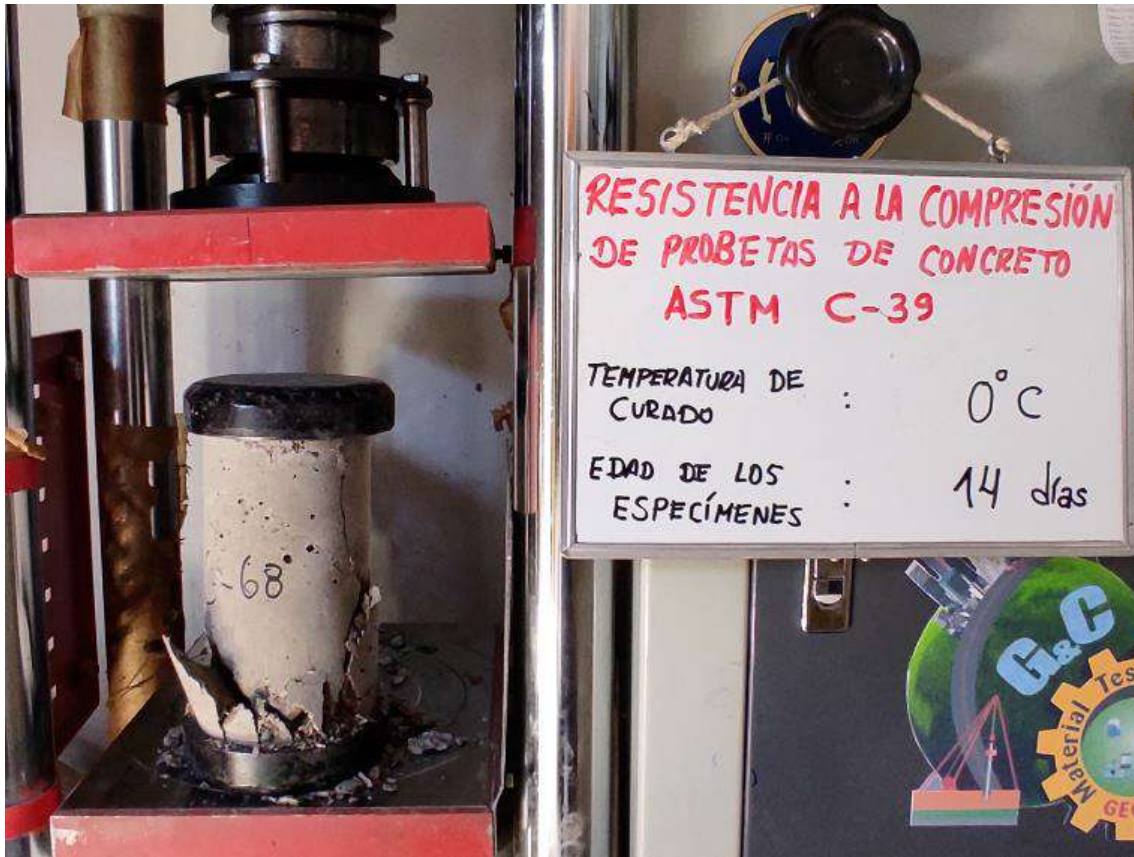
Fotografía 11. "Ensayo de Resistencia a compresión del concreto"
