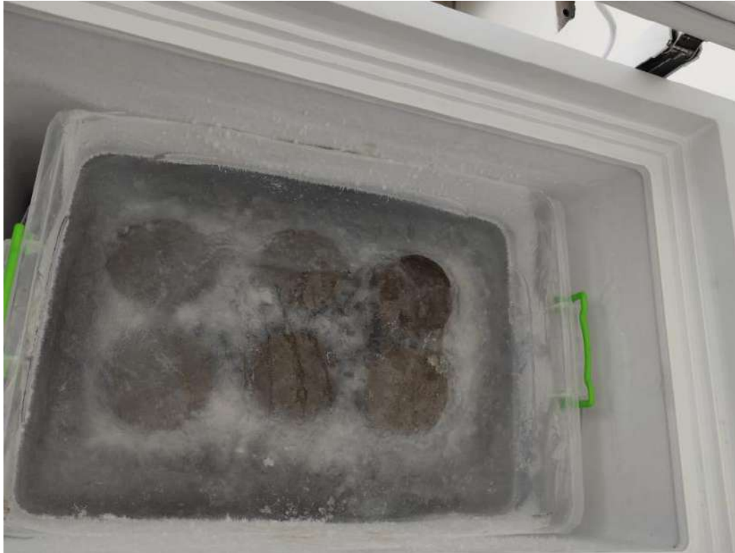
Fotografía 9. "Curado de testigos de concreto a temperatura de -5°C"
