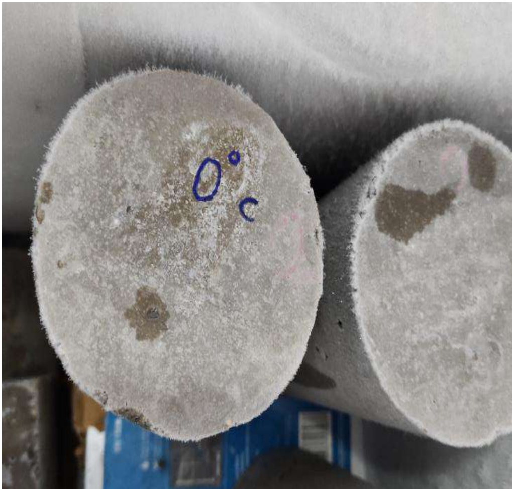
Fotografía 8. "Curado de testigos de concreto a temperatura de 0°C"
