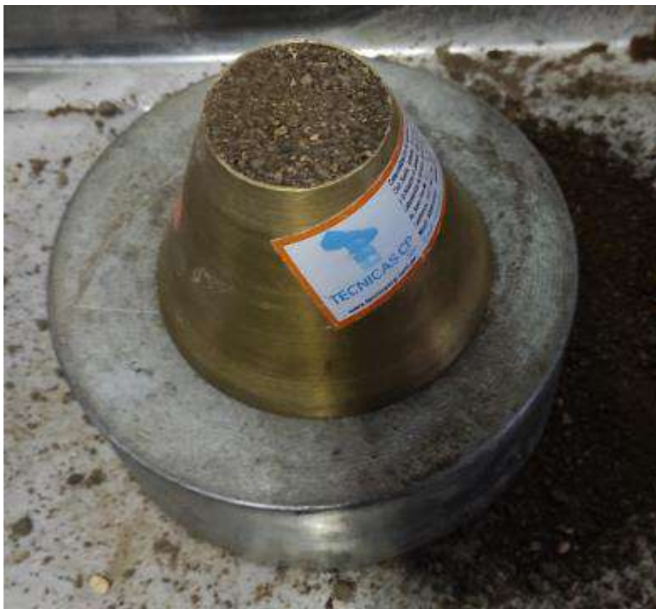
Fotografía 4. "Ensayo de peso específico para agregado fino"
