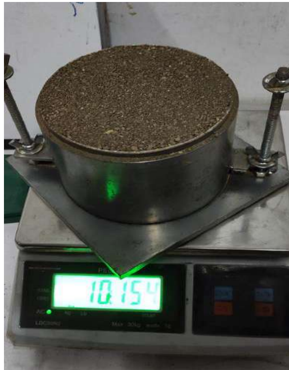
Fotografía 3. "Ensayo de peso específico para agregado fino"
