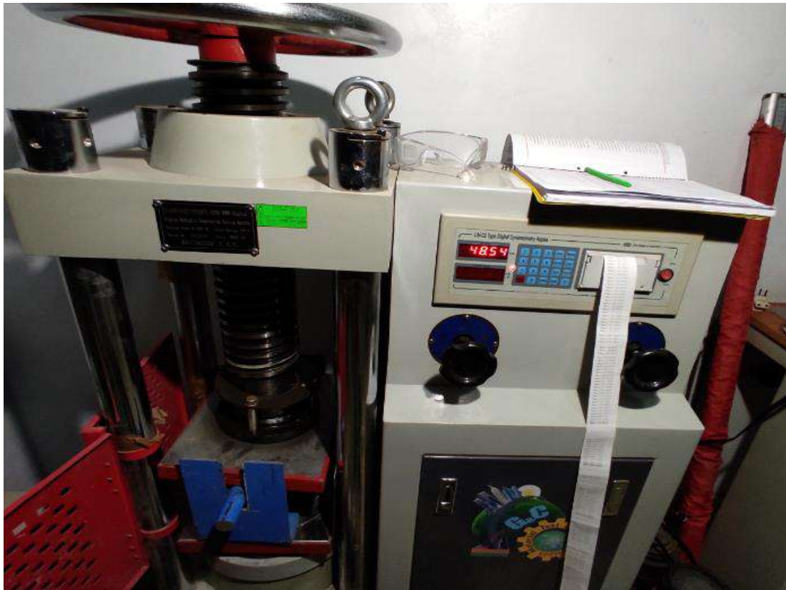
Fotografía 13. "Equipo de compresión diametral o tracción indirecta"
