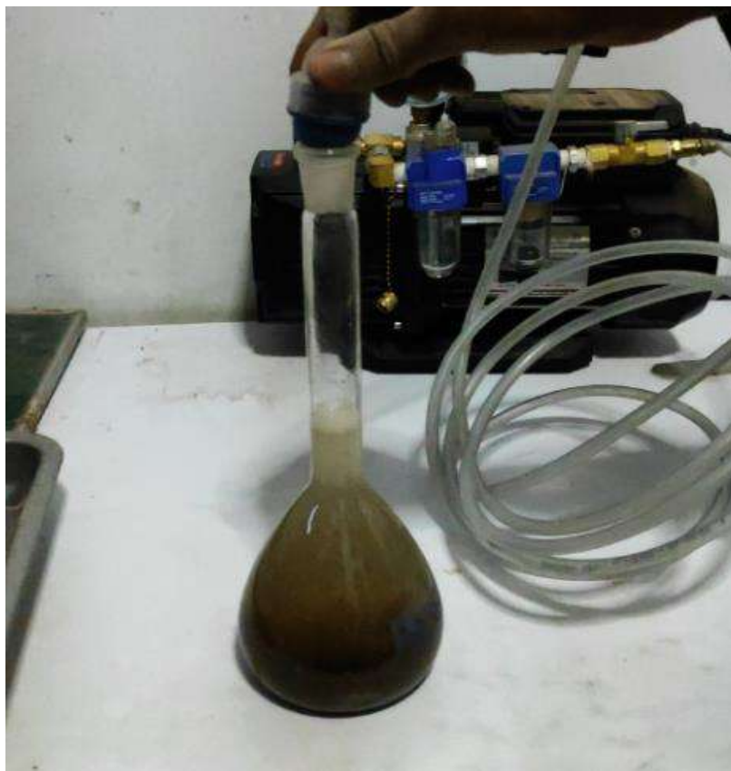
Fotografía 6. "Extracción de vacíos en la muestra fina"
