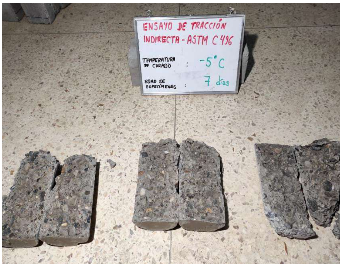
Fotografía 14. "Roturas de los testigos a tracción"
