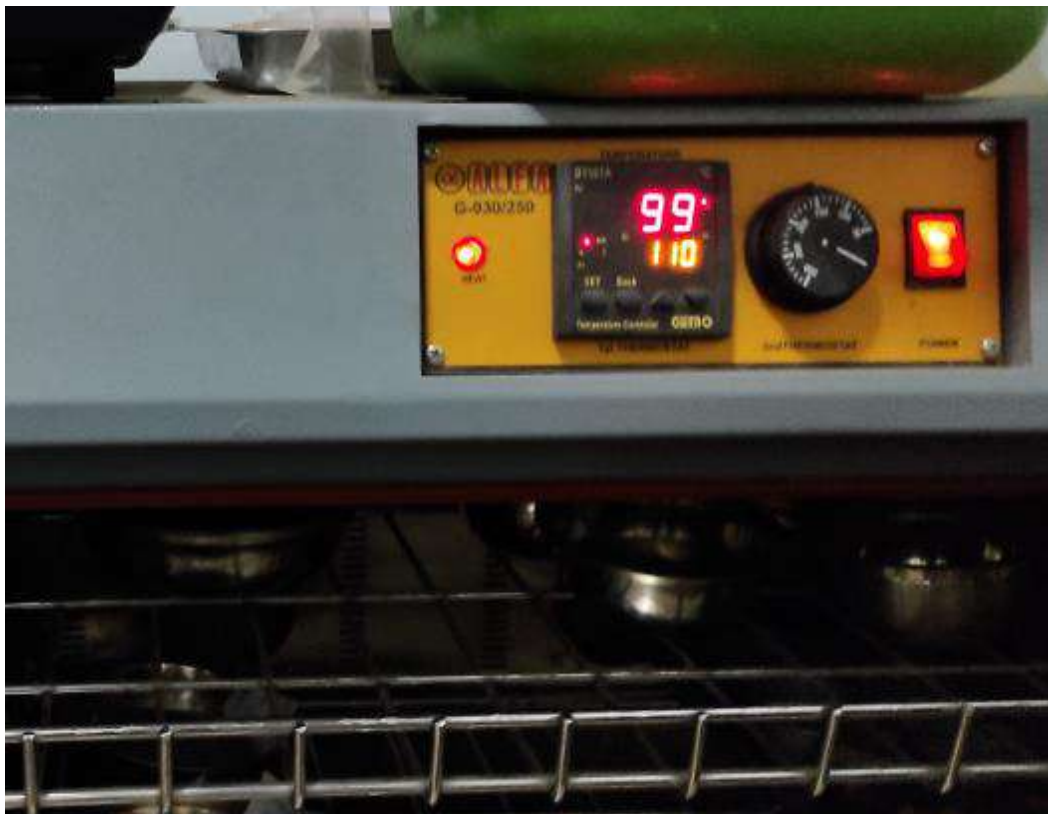
Fotografía 5. "Introducción de muestras agregado fino al Horno de 110°C ± 5°C"
