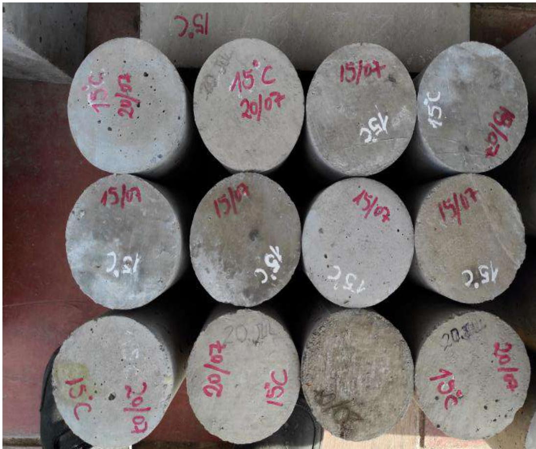
Fotografía 10. "Apilado de los testigos previos a su rotura"
