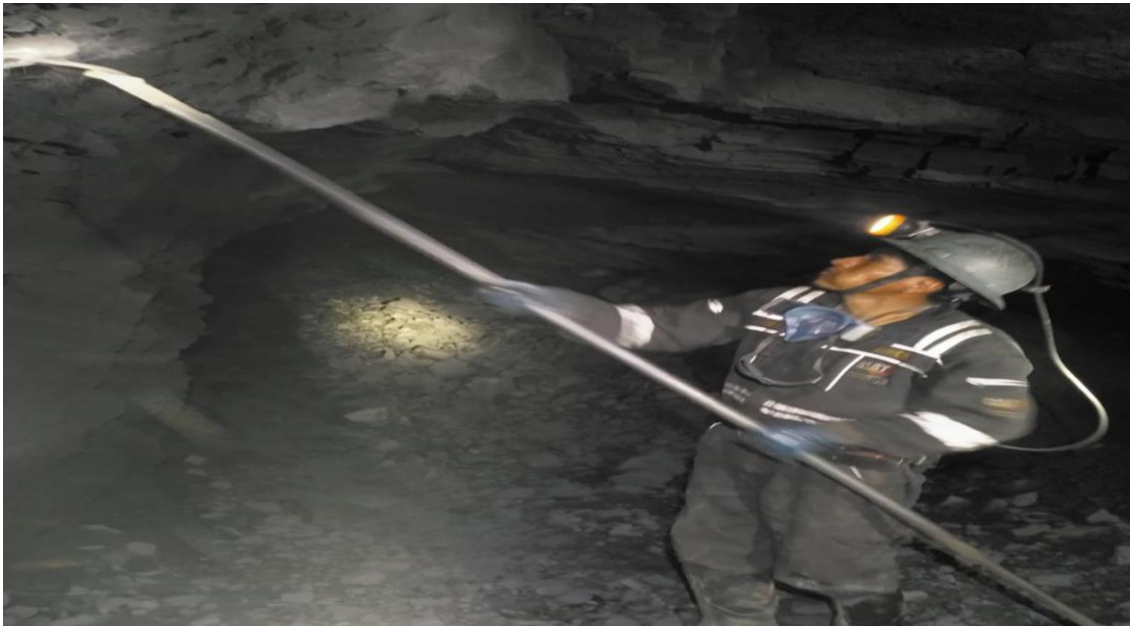
Figura 3. Correcto posicionamiento durante el desatado de rocas. Fuente: U.E.A Ana María.
