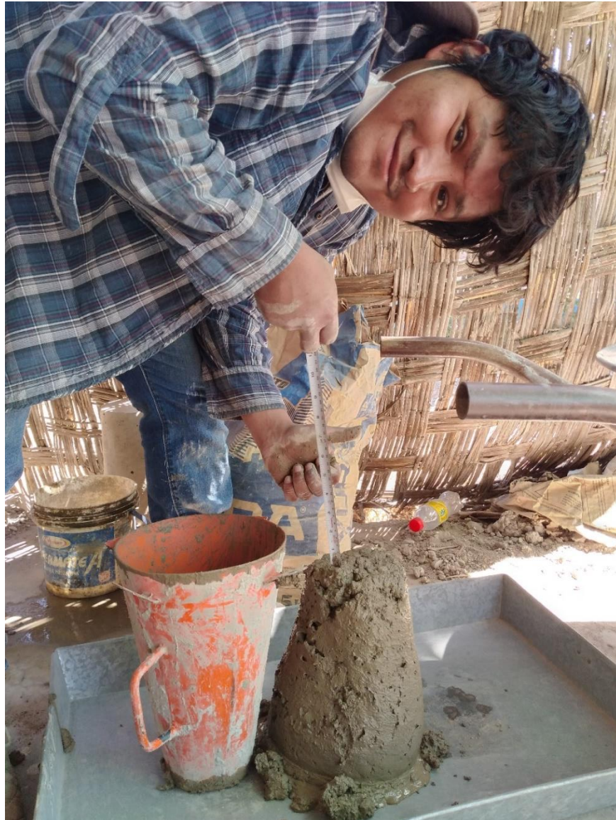
Figura 7: Ensayo de asentamiento cono de Abrams.
