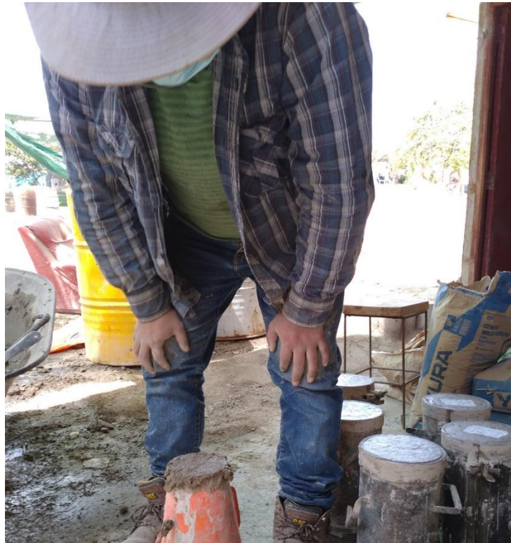
Figura 3: Elaboración de los testigos de concreto.
