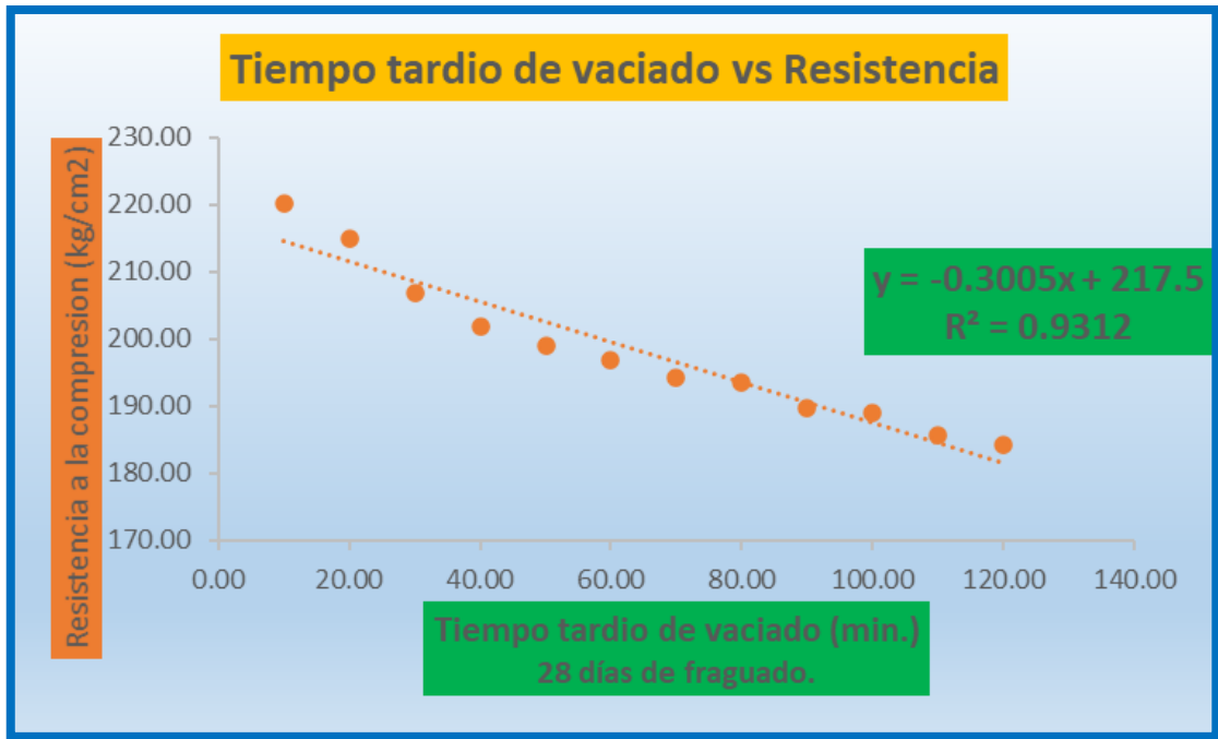
Figura 21: Representación gráfica de la correlación entre el TTVC y la resistencia del concreto de 28 días de fraguado.
