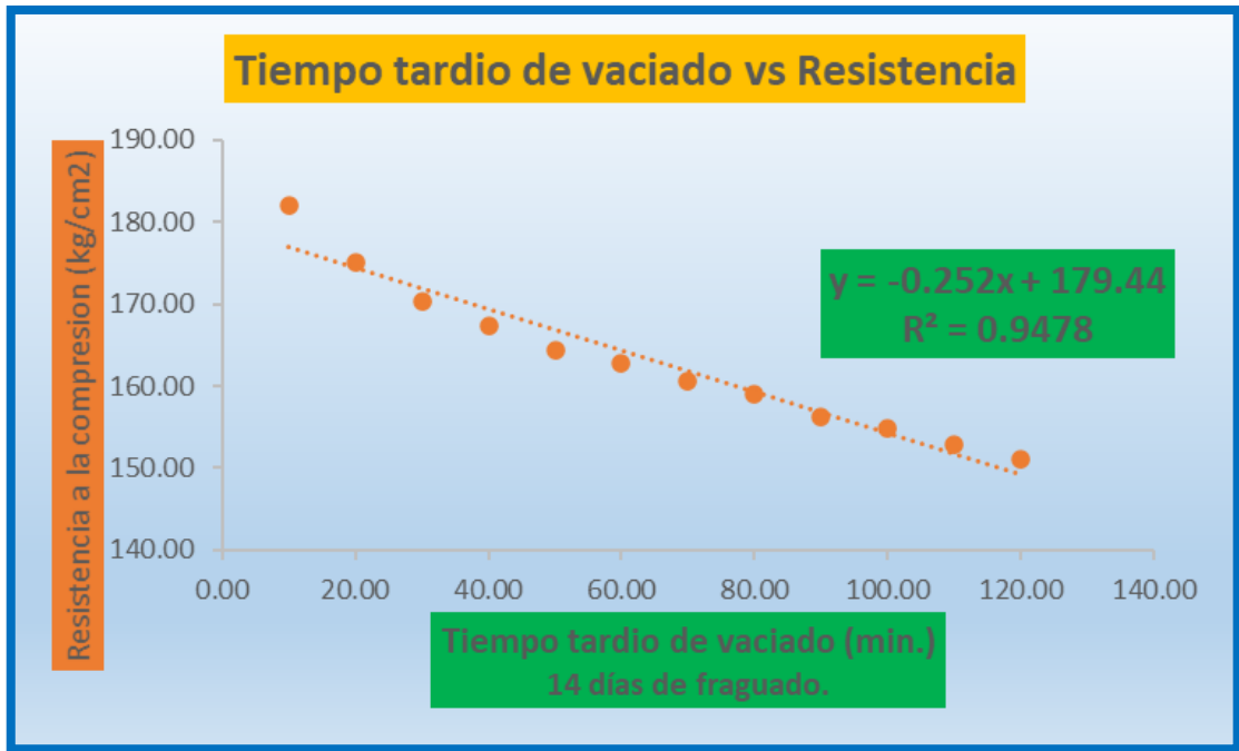
Figura 20: Representación gráfica de la correlación entre el TTVC y la resistencia del concreto de 14 días de fraguado.
