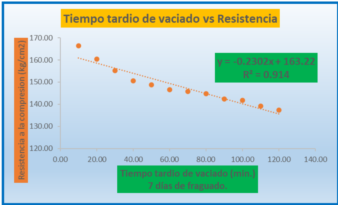
Figura 19: Representación gráfica de la correlación entre el TTVC y la resistencia del concreto de 7 días de fraguado.
