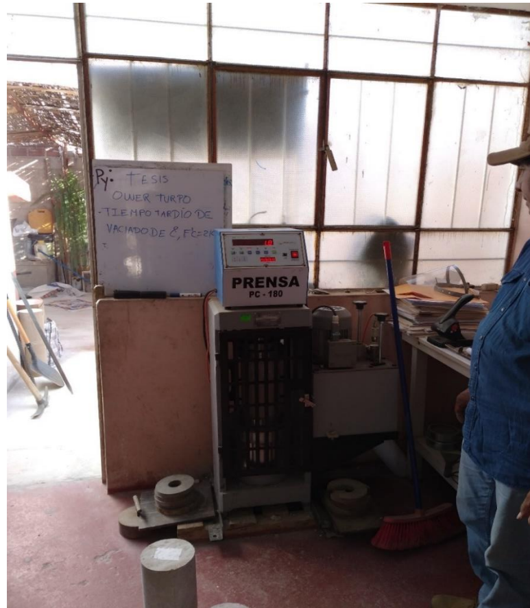
Figura 8: Ensayo de compresión del concreto.
