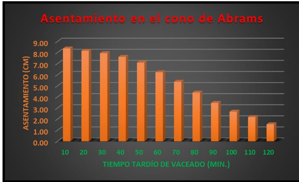
Figura 9: Asentamiento en el cono de Abrams
