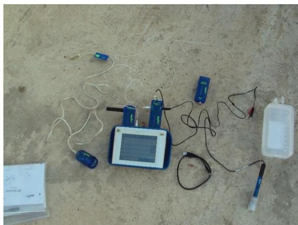
Figura 13. Fotografía de instrumento de medición (SPARK PS-2008 y sensores).
