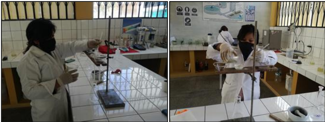
Figura 16. Proceso de filtración de cada muestra del proceso de adsorción de Zn
