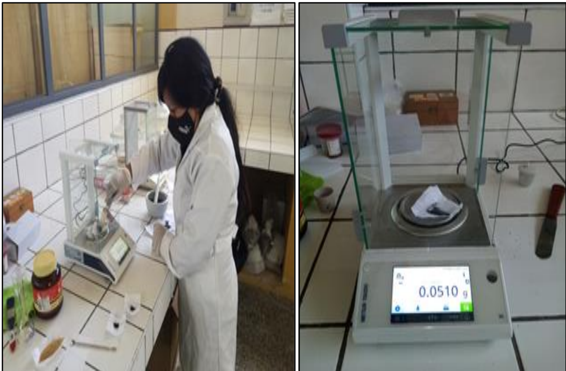
Figura 12. Pesando 50 mg de carbón activado para cada vaso de precipitado
