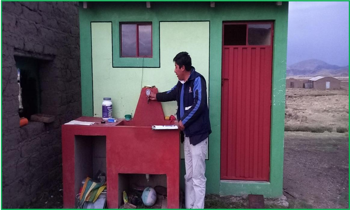
**Figura 16.** Medición de presiones en conexiones domiciliarias
