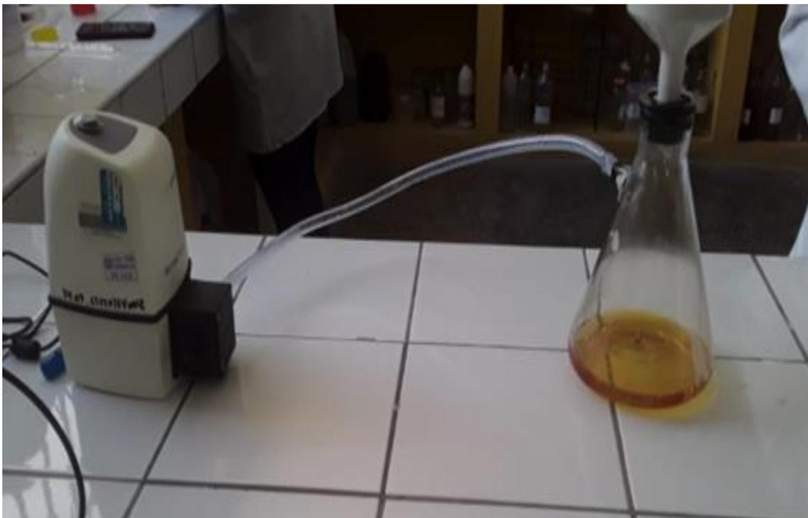
Equipo de filtración al vacío.
