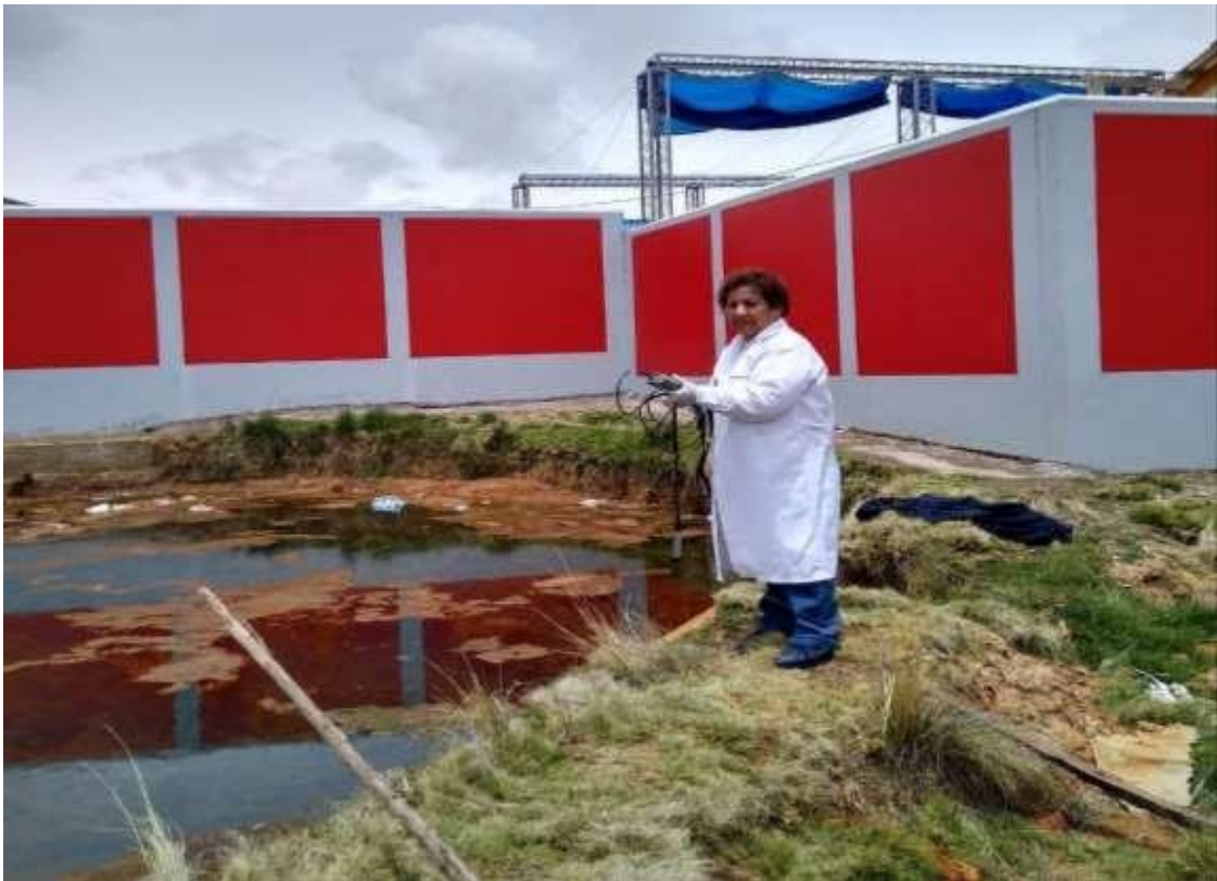
Figura 6. Toma de la muestra de la conductividad eléctrica a la profundidad del área contaminada.
