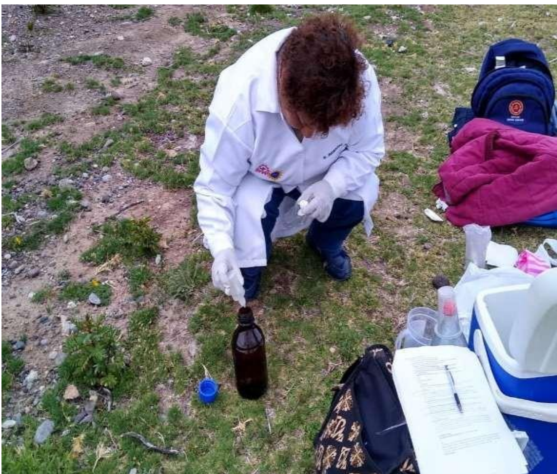
Figura 11. Preservante de la muestra de agua del área contaminada AC -2.
