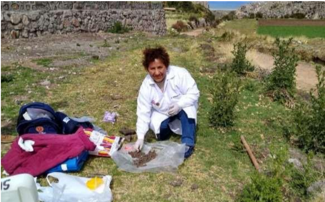
Figura 10. Cuarteo de suelos del área contaminada AC -2.
