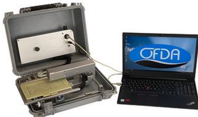
Figura 13. Equipo Del Análisis De Las Características De La Fibra (OFDA 2000)
